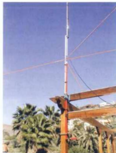
Lättvikts-GP, ca 1,5 kg, med metspö-stomme. Här monterad på uteplatsen på Gran Canaria, St Agustin.
