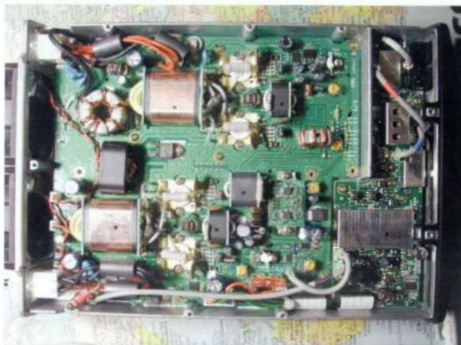
Här ses dom två slutstegen sida vid sida i TS-480HX. Längst till vänster syns fläktarna och på var sin sida om dom syns kontaktarna för spänningsmatning. Rejäl och städad design.
