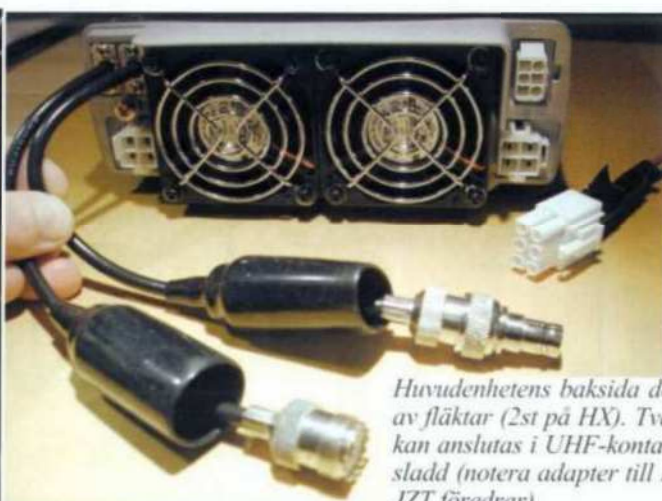
Spänningsmatningen sker till 4-poliga kontakter – Bra, dom tar mindre plats än den vanliga 6-poliga som vi ser exempel på till höger i bild. Även kontakt för styrning av extern (Kenwood) ATU syns uppe till höger.
