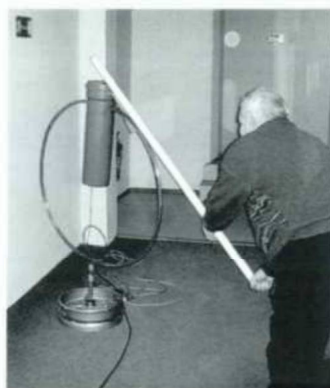
Jan demonstrerar strålningen från sin skapelse "magnet strömsantenn" som gick bättre i 5:e våningen korridoren på OE1W/ IARU (bandet var 14 MHz) än den Windom antenn de hade på taket! Testad mot SM2XHI i Långträsk.
