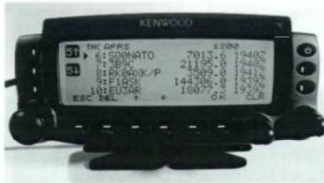
Riggens display erbjuder stora möjligheter till informationshantering beroende på applikation. Till vänster: APRS-stationsdetaljer, mitten: APRS-noder rapporterade, höger: hörda DX-clusterspottar.
