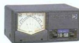
Korsvisande effekt- och SWR-mätare för 1,8 - 150 MHz. Tre effektlägen, 15/150/1500 W och dessutom PEP-mätning. Anslutningskontakter av typ UHF. Mycket bra kvalitet!
