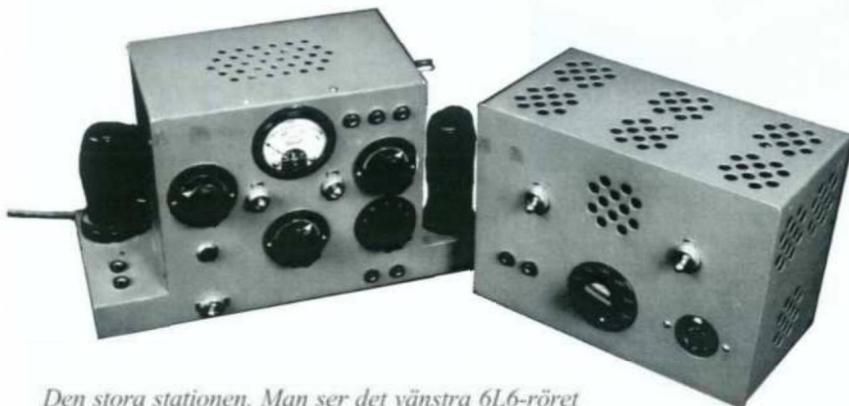
Den stora stationen. Man ser det vänstra 6L6-röret och två hylsor för kristallen. Röret kan drivas antingen som kristalloscillator eller med variabel frekvens och ratten under instrumentet bestämmer frekvensen med hjälp av en kalibreringstabell. Överst till höger tre antennhylsor. Kraftaggregatet till höger har omkopplare för 50, 100, 110, 125, 140, 180, 200, 220 och 245 volt. Läget 140 volt skall användas för drift med vibrator från likströmsnät
