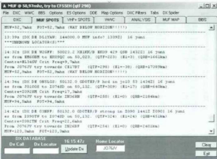
(fig. 2) Samma information, med angivet avstånd, kritisk frekvens, riktningar, elevation mm, dels mellan de spottade stationerna och dels från mitt QTH till tänkt motstation.
