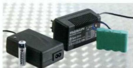
Laddningsbara NiMH-batterier är i dag mycket populära. Företaget Mascot introducerar nu två nya snabbladdare, 2015 och 2215, som arbetar med spänningsreglerad laddkontroll (-dV). Båda modellerna är utrustade med en programmerbar mikroprocessor som gör att de kan omprogrammeras till andra laddfunktioner som -dT, +dT/dt, 0 dV samt endast timer. Utöver detta kan följande parametrar justeras: säkerhetstimer, start timer och top-off timer, -dV nivå och +dT/dt nivå.
