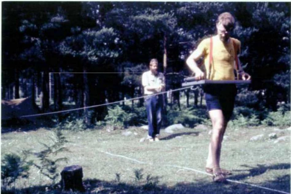
En slingram, vars sändare och mottagare är förbundna med 40 meter kabel, användes för att leta vatten under markytan. Vattnet ger signal som kan betyda vattenfylda grottgångar. Idag används ett mer lätt hanterligt VLF-instrument och GPS för snabba analysresultat.
