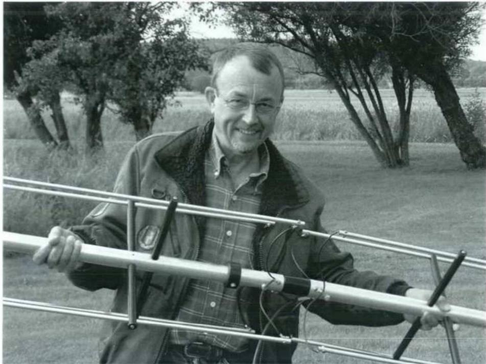
Så här ser både jag och mittdelen av antennen ut. Lägg märke till lässkruvarna för elementen på acetal-isolatorerna, samt det undre stagfästet. Du ser också hur koaxialkabeln är ansluten.
