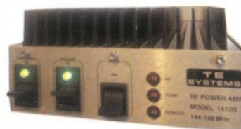
Effektsteg 144MHz TE-Systems 1412G med inbyggd preamp. 2-50W in = 15-200W ut. Pris 3550:-
