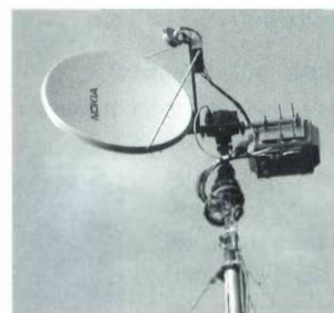
Ovan: Närbild på parabolen för 2,3 GHz, 5,7 GHz och 10 GHz som manövreras med hjälp av två rotorer.
