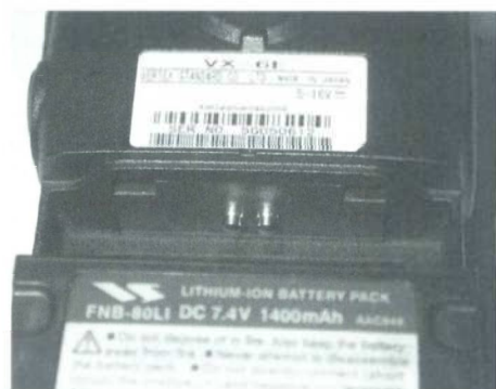
Djupt där nere sitter kontakten för att ansluta extern monofon eller kabel för programmering av riggen via PC. Batteriet är på 7,4 Volt och 1,4 Ah. Kontaktarna är förgyllda och fjädrande. Allt gör ett rejält intryck.
