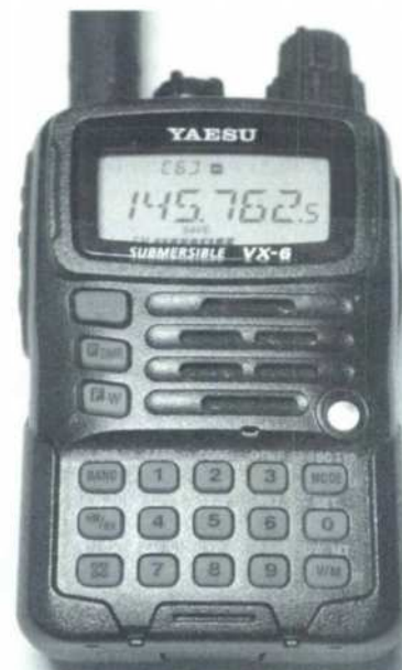
Ganska rejäla knappar på ovansidan. Knapparna på framsidan är trots sin litenhet lätta att hantera så länge man undvik tumvantar. De flesta har minst dubbelfunktion.
