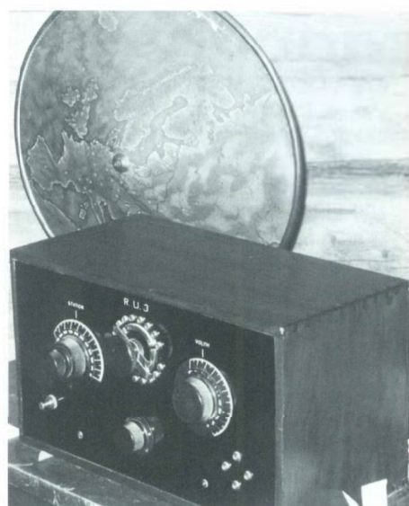
Trerörs mottagare med återkoppling, beteckning RU3. Tillverkare Ralf A Uddenberg, Göteborg 1926. Nypris: 239 kr utan rör och tillbehör.
