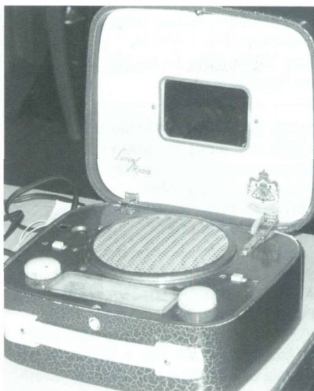
Superheterodyn-mottagare, reseradio för nät- alt. batterianslutning. Inbyggd antenn i locket, var mycket populär bland damerna på 50-talet p.g.a. spegeln i locket!
