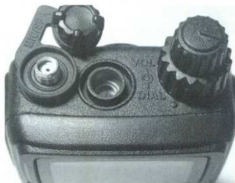
Djupt där nere sitter kontakten för att ansluta extern monofon eller kabel för programmering av riggen via PC. Batteriet är på 7,4 Volt och 1,4 Ah. Kontaktarna är förgyllda och fjädrande. Allt gör ett rejält intryck.
