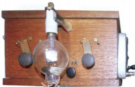
Lee De Forest triodrör i original - grunden för radioteknikens utveckling fram till 1950-talet då transistorer kom. Detta är ett originalrör, som är mycket sällsynt. Tillverkat 18 feb 1908.
