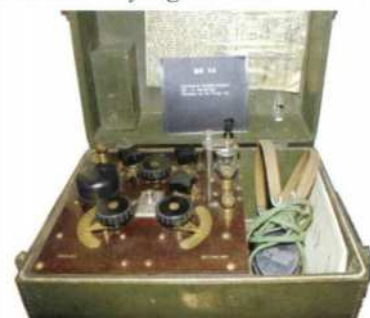
BC 14 Amerikansk kristallmottagare från första världskriget. Tillverkad av De Forest Inc.
