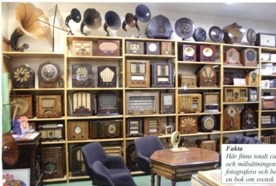
En samling småapparater från 20-talet. Längst till vänster tyska apparater fabrikat Löwe med det första röret med tre rörfunktioner och inbyggda passiva komponenter. Världens första integrerade krets.
