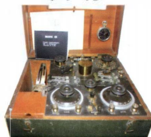
Militär engelsk kristallmottagare från första världskriget. S.k Trench set, användes i skyttegravarna.
