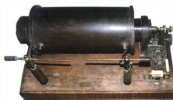
Den första gnistsändaren av fabrikat Marconi från sekelskiftet. Användes som reservsändare på fartyg, t.ex Titanic.
