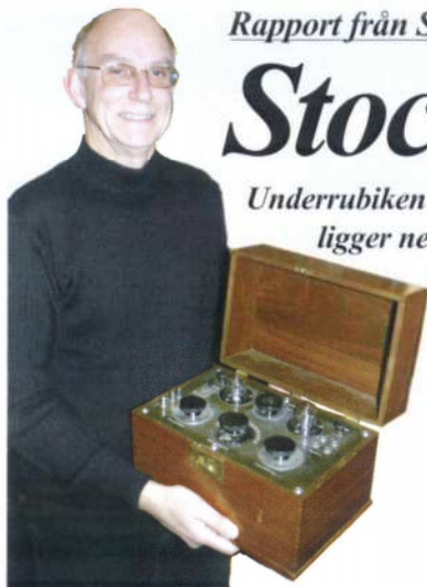
Den första rundradion tillverkad av SRA, Svenska Radio AB (Radiola) i början av år 1923. Typ M15 för återförsäljaren Albert Bonnier AB.
