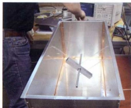
Antennelementen mäts upp genom att de placeras i en sådan här kavitetslåda. Med locket pålagt och fastskruvat kan den liknas vid en omvänd Faradays bur.
