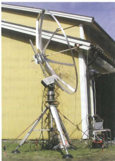
1,8 m parabol riktad mot månen för mottagningsprov av månstudssignaler den 16 april 2005
