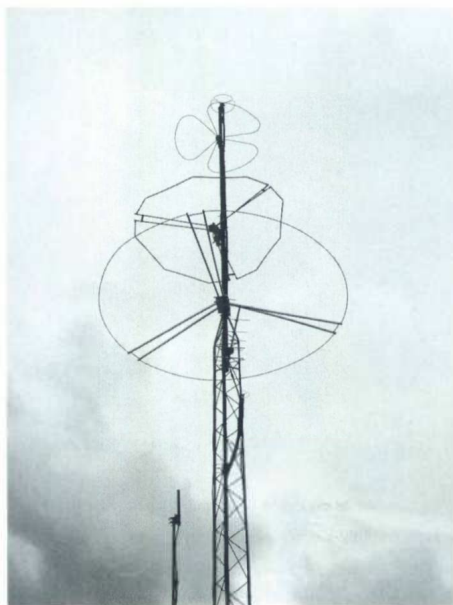
Fyren OZ7IGYs Antenner Nerifrån på 98 m höh BIG WHEEL på 1296,930 MHz matad med 10W. På 99 m höh 6 el YAGI på 432,471 MHz matad med 25W för aurora och är rikad mot SMQ. På 100 m höh Alfa slot på 2320,930 MHz matad med 5W. På 100, 102, 104 och 105 m höh BIG WHEEL för 50,021, 70,021, 144,471 MHz respektive 432,471 MHz, matade med 25 W. Fyren har under 24 år suttit på Ålborg Portland-fabriken och den 10 augusti tystnade de sista delarna på 5,5 och 10GHz-fyrarna och flyttas till det nya QTH:et efter renovering och översyn. De har blivit lovade att OZ7IGY skall få sitta där den nu är i minst 24 år på nya QTH/QRA Jystrup/J055WM
