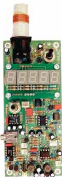
DIPPER heter griddip-byggsatsen från DL-QRP-AG i Tyskland. Byggsatsen levereras med låda och byggbeskrivning kan hämtas på webbplatsen [3] för studium.
