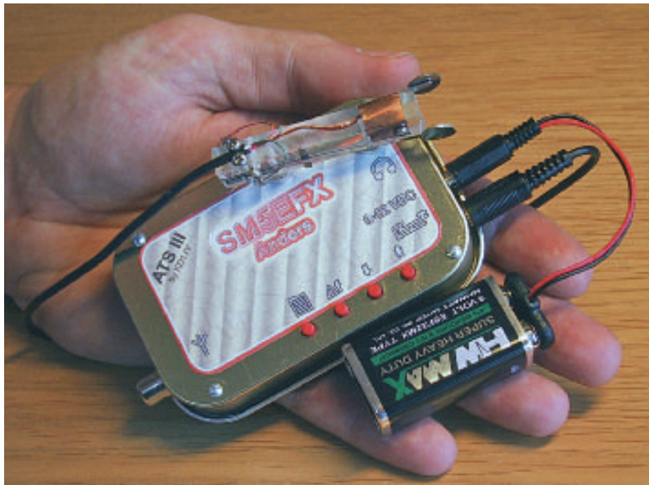
En komplett CW-rigg på 3 watt som lätt ryms i handen, kan vara ett utmärkt sätt att återaktivera en radioamatör.
