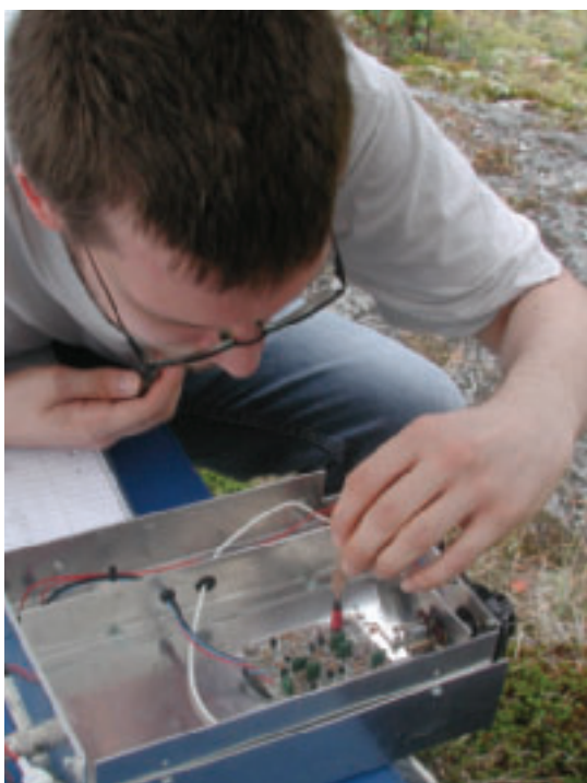
När en VFO behöver trimmas i fält får en "skogspinne" duga som icke magnetisk trimmejsel. SM0YSR flyttar den egenbyggda VFO:n till 80meter CW-del.
