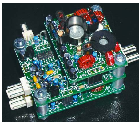
Softrock version 6 med exitern och slutstegsmodul på ca 1 watt. Bild: N1RX
