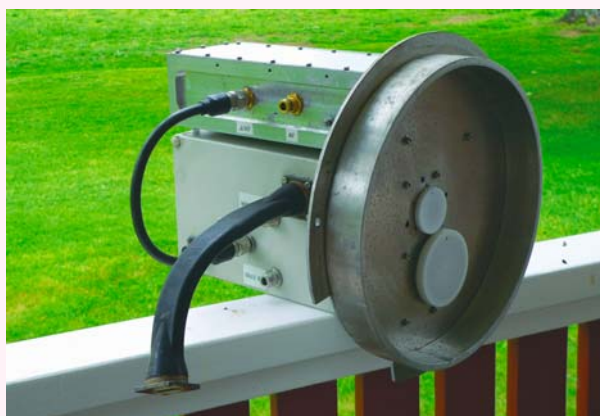
Feedhornen för 3 och 6cm. Överst sitter TWT- förstärkaren för 6cm
