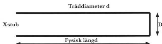
Figur 1: En stub består av två parallella ledare som är kortslutna i borte änden. Till vänster i figuren erhålls en positiv reaktans.
