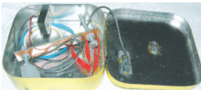
Armen till telgrafinyckeln består av en bit kopparlaminat och packas ned lös i asken, sånär som på att det sitter en fastlödad tråd i den.
