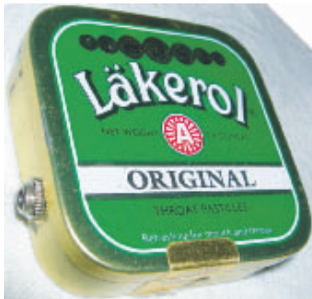
Läkerolasken i stängt läge, det enda som syns från utsidan är en 3,5 mm teleplugg.
