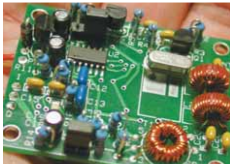
Varsågod! En handfull radio att bygga själv. SoftRock version 6.
