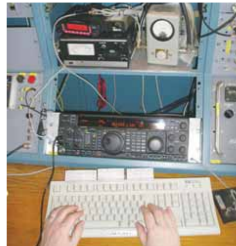
Stationsplatsen med tillhörande transceiver, clusterradio, effektmeter och keyboard för dator.
