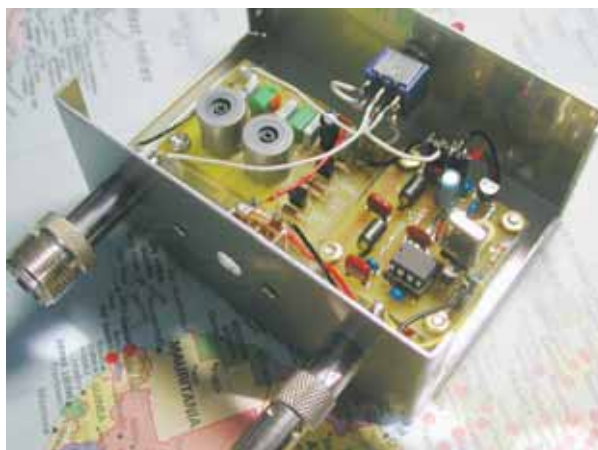
En liten låda för långa vågor. Till höger en konverter och till vänster en förförstärkare och preselektoroption. Bygg denna och kom igång med lyssning på riktigt långa vågor.
