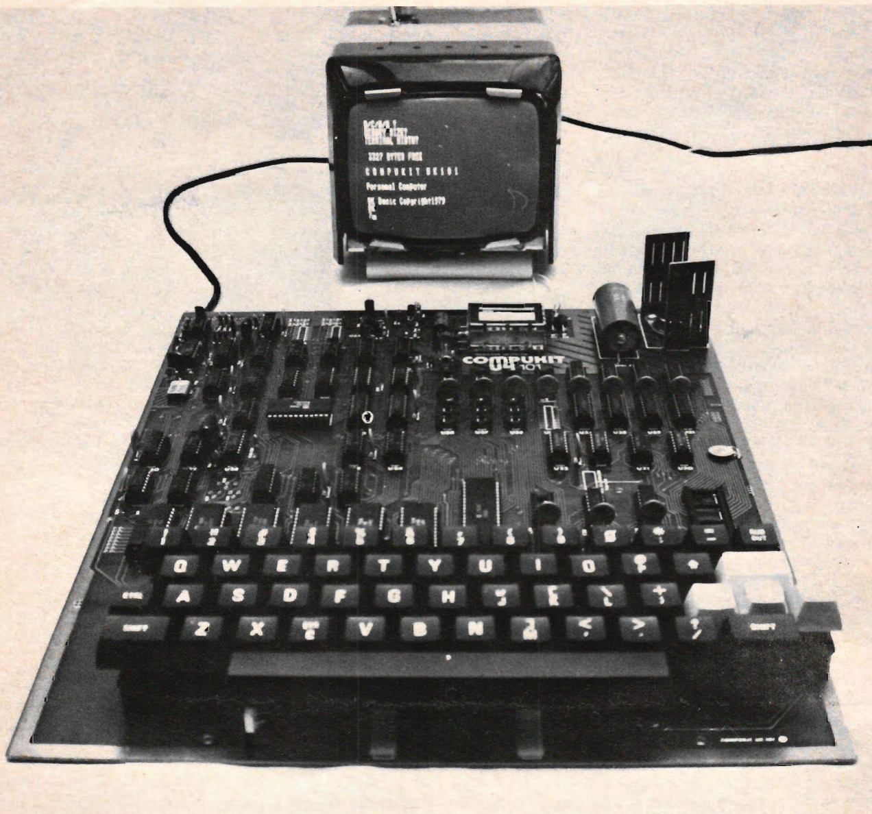
Fig 3:5. Compukit 101. Basic-dator på ett kort för anslutning till tv.
