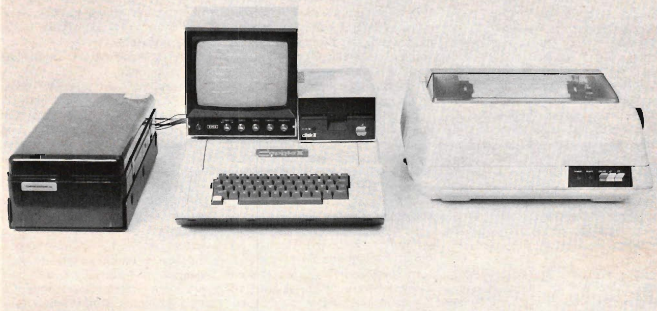
Fig 3:9. Apple II har här fått "stordatorkapacitet" med anslutning till winchesterminne (40 Mbyte!), flexskivenhet och skrivare.
