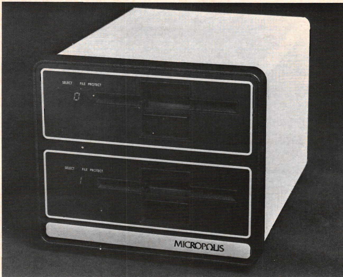
Fig 7:1. Så här kan en flexskivenhet se ut, eller rättare sagt två enheter, monterade på varandra. Tillverkare är Micropolis, ett ungt framgångsrikt amerikanskt företag. Andra exempel är Shugart, Pertec, BASF, Siemens, MPI, Teac m fl. Vanligast är 5 1/4" flexskivor men 8" skivor förekommer även i amatörsammanhang. Tidigare har skivminnena varit för dyra i smådatorsystem, men där råder nu en intensiv utveckling och priserna rasar. Skivminne, i s k Winchesterteknik, finns nu att få med kapacitet upp till 20 MByte för anslutning till smådatorer.
