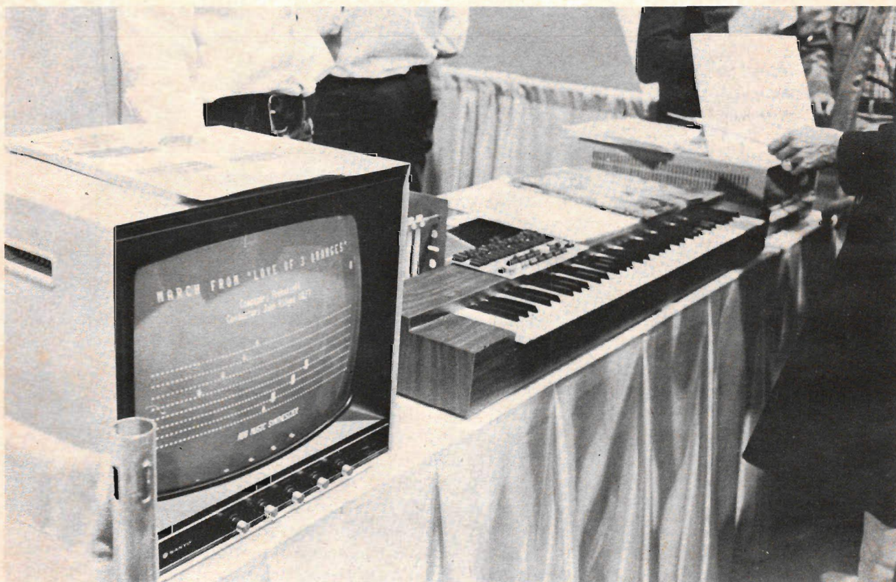
Fig 1:1. En av de mera spektakulära tillämpningarna av datorn är skapande av musik. Anläggningen på bilden tillverkas av ALF, USA. Musiken genereras i ett kretskort som passar i datorer med S-100 buss. Märk presentationen av noter på bildskärmen.
