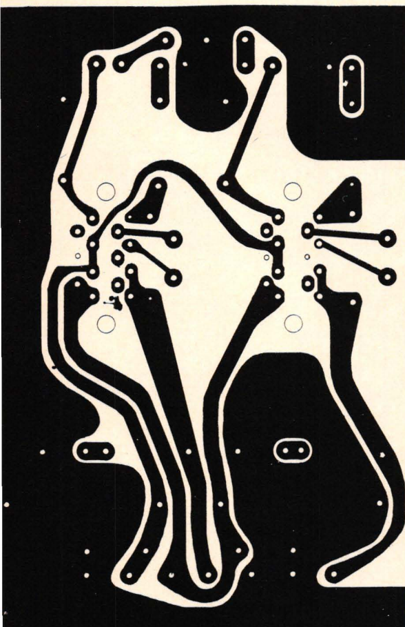
Fig 7. Kretskortsmönstret för stereoslutsteget. Mönstret är här visat i skala 1:1.
