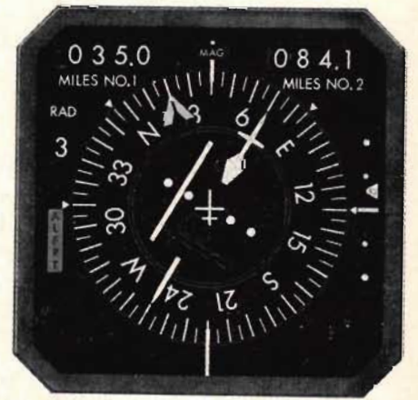
Fig 3. Samma tillverkares HSI, horisontalsituationindikator, RD-350A, för denna flygplanstyp. Märk distansangivelserna upptill. ▶
