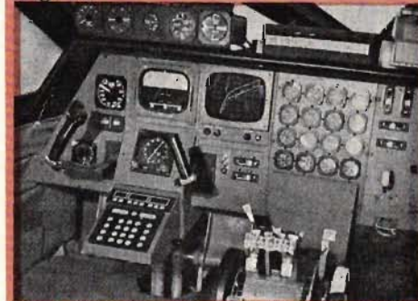
Fig 3. Tva av Boeings tekniker — av vilka en är projektpilot — har byggt denna mock up eller fullskalemodell av en tänkt simulator för det kommande överljudsplanet. Man tänker sig styrkolonnen framför piloterna ersatt med den här typen av panelinfästa "handtag", vilket medför fördelen av oinskränkt synfält mot EADI, navigations-systemens presentationspanel samt konsolen för inställning av gällande värden. EADI i mitten i v är av Sperrys fabrikat och uppges mycket känslig för ändringar i färdriktningen. Visar också längdlutningsläge och vertikallrörelse separat för tex sjunkande rörelse med nosen pekande uppåt. "Monitorn" t h förklaras längre fram.
