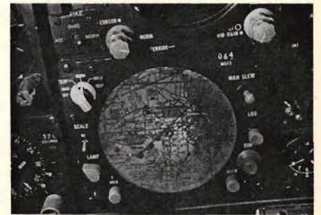
Fig 1. Computing Devices kartprojektor sådan den ser ut installerad i en av USA-marinens A-7E-attackplan. Bilden visar även en del av en radar av multi-modetyp från Texas Inst. (överst i bilden).
