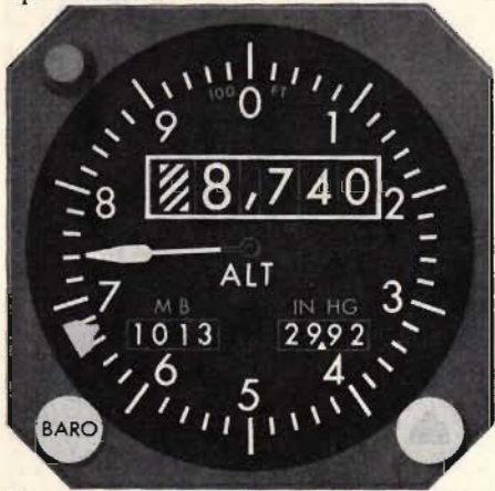
Fig 4. Höjdmätare för DC-10 i standardutförande från Sperry. Kan datoranslutas enligt ARINC-norm. Visarpresentationen ger höjderna mellan tusenfot-nivåerna. Instrumentet ger numerisk display för läge och magnethjulspresentation för 10 000-, 1 000- och 100-siffror samt analog presentation av läge mellan nivåer i jämna hundra fot. (Olika symboler i instrumentet betecknar "under havsnivå", "mellan havsnivå och 10 000 fot" samt "över 10 000 fot". Märk värdena i millibar resp. Hg i "fönstren" nedtill. Vid kritiska lägen träder planet "felövervakningsmonitor" i funktion och som den är kopplad bl.a till höjdmätarna, inträder "avflaggning" med rött ("OFF") i den numeriska delen.
