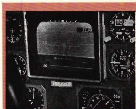
Fig. 1. General Electric Avionic Controls har utvecklat denna EADI som här ses installerad i en DC 10-simulator hos McDonnell-Douglas. Kalligrafisk skrivare, digitalt raster för symbolpresentationen kännetecknar bl a systemet som är helelektroniskt och kan visa datafakta på skärmen, samtidigt raster för denna utgör TV-bildrör. De avkännande organens förstärkning kan regleras, liksom avbildningsskalan för hela projektionen. GE avser också presentera data i två färger på röret i en ännu mer utvecklad version.
