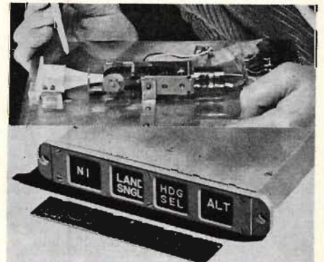
Fig 1. Bendix tablå för olika operativa tillstånd hos DC-10. Fiberoptikdisplay, 16 mm filmslingor i ändlös kassett kännetecknar enheterna som kunnat hållas mycket små men ändå "stora" i ljusutbytet från symboler och teckengrupper.
