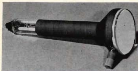
Fig 9. Avkänningsröret i EVR-uppspelningsenheten. "Skärmen" är överdragen med ett skikt av P-16-fosfor.
