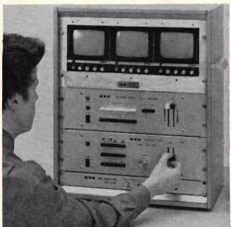
Ministudioutrustning från Ikegami, bestående av PM 52-monitörer, videomixer för sex kameror, trickmixer samt synkgenerator.
