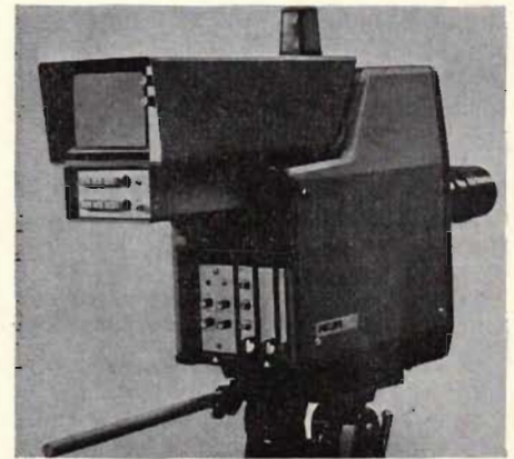
Modulbyggd kompaktkamera för färg-TV, Philips LDH 1.
