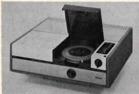
Fig 8. a) EVR-spelaren sådan den hittills utförts. Nyare modeller kommer att göras avsevärt mindre. b) Ett exempel på detta är prototypen från Bosch som visas här.
