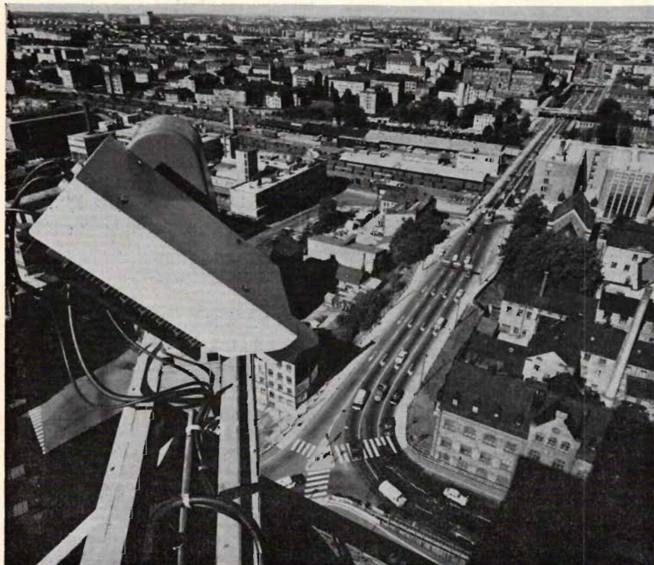
Kompaktkamera för utomhusanvändning, Philips PM 1001. Bilden visar en installation för Stockholmspolisens nya trafikövervaknings-TV.
