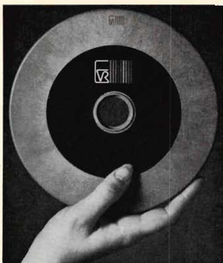
Fig 4. EVR-kassetten har 18 cm diameter och tjockleken är 18 mm. Filmen ligger inkapslad och oåtkomlig för föroreningar.
