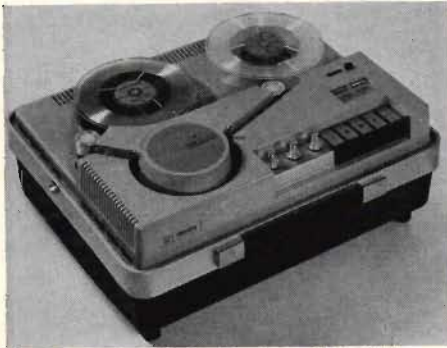
Philips minsta videobandspelare, LDL 1000, med 1/2" band, avsedd för hemmabruk och undervisning.
