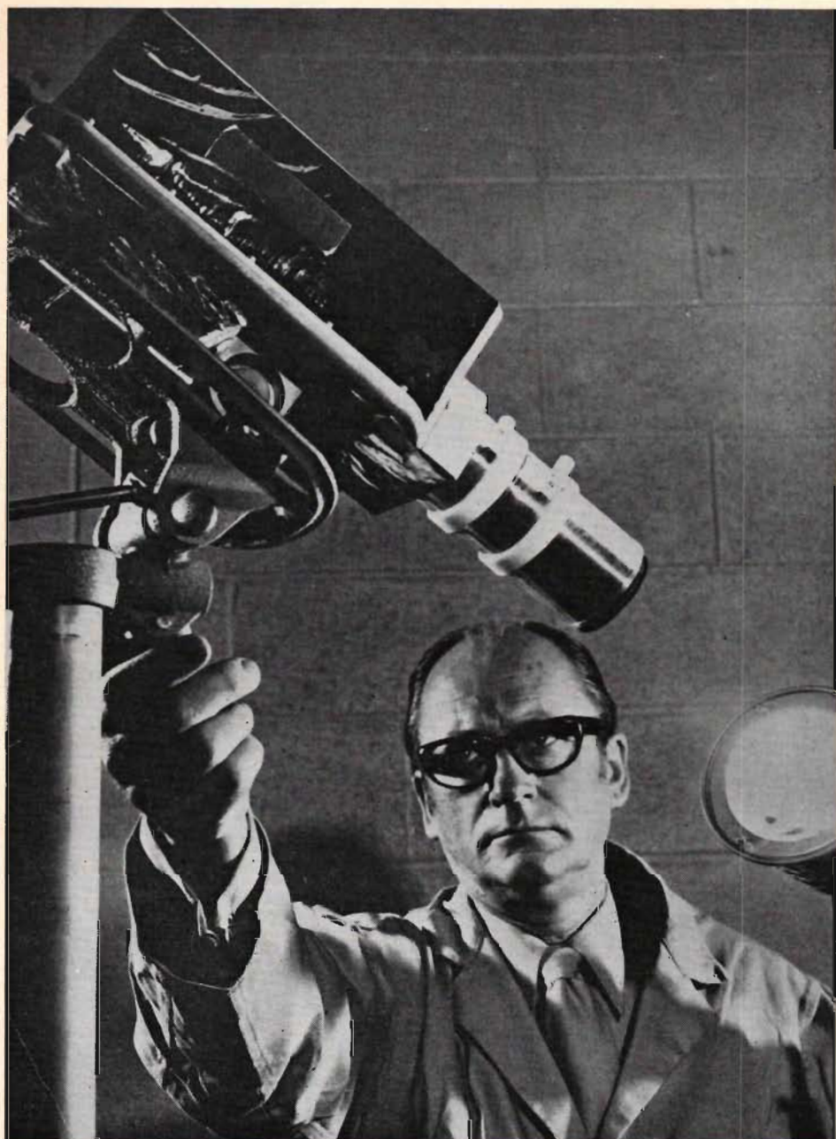
Fig 2. Demonstration med RCA:s "space color camera", som visar att en strålkastare kan riktas rakt in i objektivet utan att skada kiselvidiconen.
