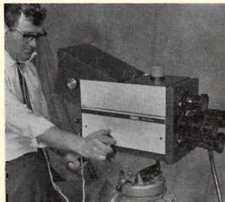
EMI 2004, systemkamera med elektronisk sökare och objektivrevolver.
