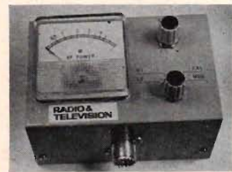
Fig 2. Det färdiga instrumentet, inbyggt i en minibox med måtten 120 x 60 x 80 mm ( Elfa K 466 ). Skjutomkopplaren som står på den i RT 2/1970 beskrivna enklare uteffektmetern var placerad under panelinstrumentet har blivit överflödigt och tagits bort. Hålen efter omkopplaren döljs lämpligen med en efter byggarrens smak avpassad märkskylt.
