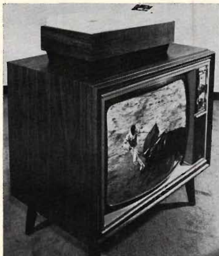
Fig 1. De första prototyperna till SelectaVision bestod av "bandspelare" med öppna spolar som roterade. För produktion har man bestämt att spolarerna ersätts av en kassetmaskin som på bilden här. Den ställs tex ovanpå TV-mottagaren. Längst upp th ses slitsen där man stoppar i kassetterna med plastfilmen som bär programmaterialet.
