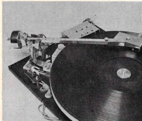
Fig e. Här syns tonarm och magnet vid innerspår (pick upen 5,8 cm från centrum). Magneten påverkar reläet, som befinner sig rakt under.
