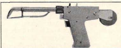
Fig 5. Lödkolv med "inbyggt" lödtenn från Klaus Schlitt.
