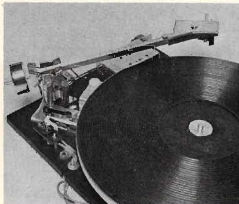
Fig d. Bilden visar tonarm och magnet vid avspelnings början. Magneten påverkar ej reläet.
