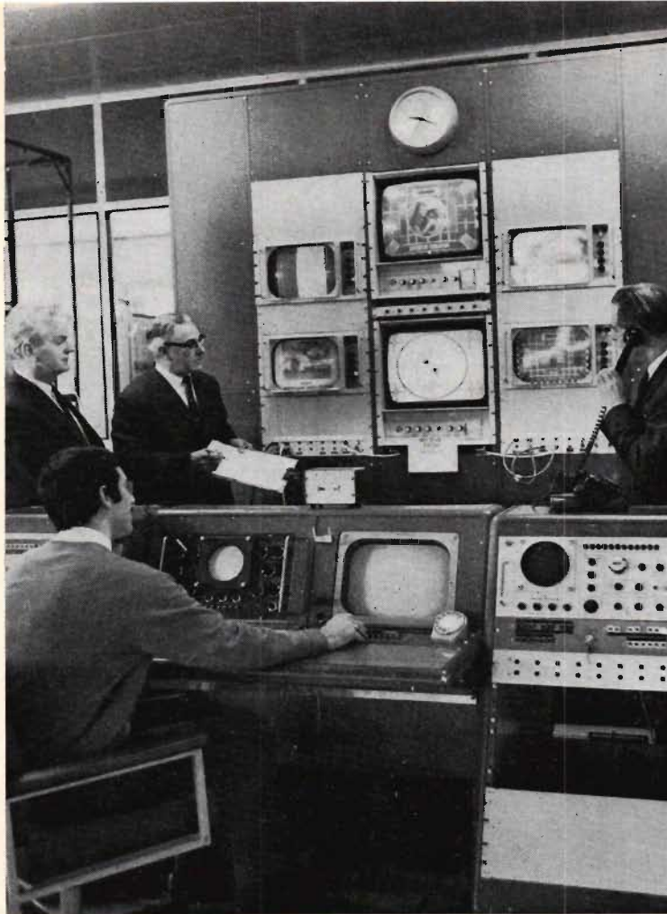
Fig 1. Test av TV-överföring från Australiens och Japans markstationer försiggår här i Goonhilly Down-stationen. Sändningarna går över Intelsat 3-satelliten över Indiska oceanen och når så Cornwall vid brittiska kusten. Dessa försök bereder vägen för de första live-TV-länkvägarna mellan England och den stora fd kolonin i Stilla havet.
