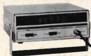
IB-101 Frekvensräknare Mätområde: 1Hz-15MHz Känslighet: 100mV till 1MHz, däröver 250mV Pris: byggsats Kr. 1.575:— Pris: monterad Kr. 1.975:—
