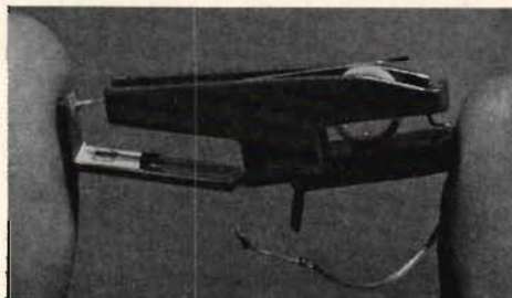
Fig 4. Hjärtat i Teldec's videoskivspelare, "pick-upen". Den kan i viss mån jämföras med en vanlig pickup, men är i stället helt orörlig och omvandlar på piezo-elektrisk väg tryckimpulserna från den elastiska skivan.
