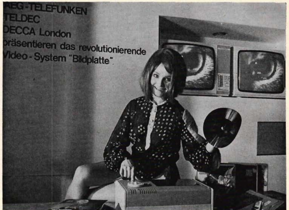
Fig 3. Teldec's unika bildplatta med avspelningsanordning.
