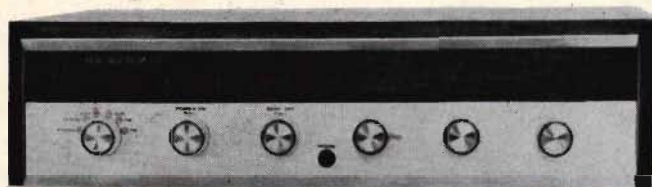
AR-14 FM Stereomottagare 2x10W Sinus, distorsion under 0,5% Pris Byggsats Kr 699:— Förstärkardelen finns också separat. Modell AA-14, Pris Kr 429:—
