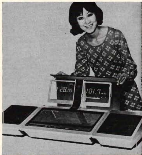
Fig 16. Flytande kristaller som indikator i radiomottagare. Detta var något som Matsushita var ensamma om. På en genomskinlig glasruta bakom mottagaren presenteras både tid och inställd frekvens. Det finns inga planer på att börja marknadsföra den i Europa än, utan den är bara att betrakta som en experimentmodell, men onekligen en intressant sådan.
