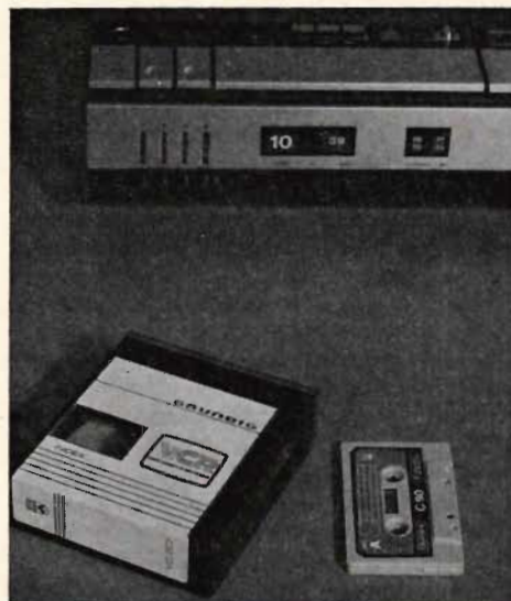
Fig 1. Grundigs VCR-maskin och videokassetten i jämförelse med en tonbandskassett. Lägg märke till digitaluret på apparaten.
