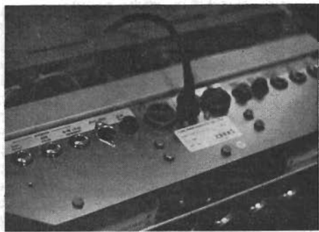
Fig 4. Här en blick in i "bakre" kontaktpanelen, som väl borde kallas den övre, rätteligen. Utseendet kan växla något, beroende på vad slags Ferrograph-variant man har att göra med. Här en tvåspars stereomaskin. Vi ser i fokus det "lägre spårets" kontakter: Linjeingång, utgångarna för lågnivå, (oberoende av volymkontrollen men påverkbar med tonkontrollerna), 600 ohm och högtalare för 8—16 ohm. Därpå en rätt märklig DIN-kontakt som är sjupolig och har en hel mängd funktioner. Det är en "auxiliary socket" för bla anslutning av fjärrbetjäningssdon. Anordningen sägs "förhöja faciliteterna och kapaciteten hos bandspelaren". Man kan ansluta 3-, 5- och 7-poliga DIN-kontakter. Två stift är för fjärrstart/stopp, tex med pedalanordning. Då sätts maskinen i pausläge. Ett stift ger upp till 200 mA dc från 50 V-uttaget i kontakten. På stereomaskinerna är lågnivåutgångarna kopplade till två av stiften, och 600 ohms-utgångarna till två andra, härvid möjliggörande anslutningar för fjärrbetjäna volymkontroll, do nivåindikering och signalpåverkad omkoppling, m m.
