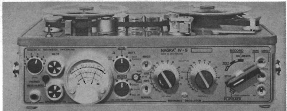
Fig 7. Nagra IV-S, där S står för stereo. Maskinen är primärt tänkt för masterbruk vid skivframställning, se RT:s aprilnummer för presentation och huvuddata. — Det har visat sig, att man gärna använder S-versionen t ex inom filmindustrin för tvåspårsregistrering och inte för stereo; det är tacknämligt att tillgå tvåkanalbandspelarens möjligheter om man från en scen till en annan vill ha föregående scens ljud eller effekter kvar över den nya bilden, som kan vara t ex en zoomning från föregående inställning eller en avstånds bild av en person, vars röst man hört nyss och som man vill ha liggande kvar.
