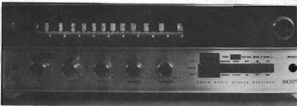
Fig 8. "Scotten" har inga yttre kännetecken på funktionsdubblingen mer än att Telestyrelsens tekniker tejpjat på märkning vid omkopplaren tv där de olika slagen av stereomottagning väljs och th där under "stereo" M- resp S-kanalen kan väljas genom trycktangent. FCC tv är lagd över gängse stereo-mode i ingångsväljaren, M och S mm har erhållits genom att receivers loudnessfunktionsval borttagits — loudness är konstant inkopplat nu, och vidare har en filterfunktion fått utgå.
