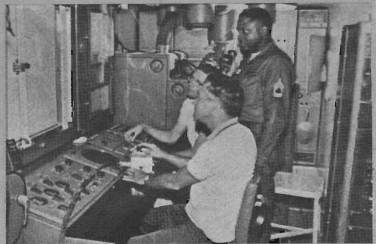
Fig 5. Här är "kontrollrummet" varifrån Cardinal m fl leds. Normalt behövs inga tre man "vid rodren". "Piloten" sitter längst ut med sin lilla kontrollbox. Han tycks ha visuell kontakt med den snabbt försvinnande "dronen" ännu — men så fort den försvunnit ur synhåll följs miniplanets av den spårande radarn. Signalen länkas in till skärmen och plottingskretsarna i "hytten" som skulle kunna vara belägen på ett fartyg, f ö. Man har etablerat följning på mycket stora avstånd, ca 12 svenska mil nämns av tillverkaren.
