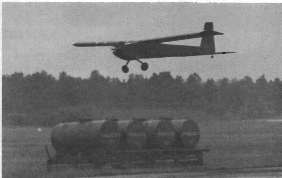
Fig 2. Radiokontrollmodellen har lättat och läggs i kurs och rätt stigvinkel. Man märker bla den tjocka vingprofilen och de breda, rektangulära vingarna med klippta spetsar för goda flyg- och lastegenskaper — avsikten är ju inte att sätta fartrekord. — Foto Gun Sörlin, FOA.
