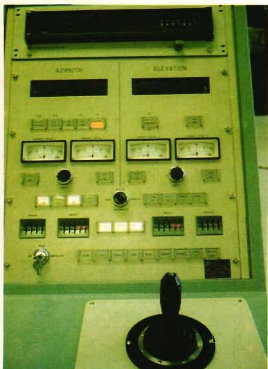
Kontrollpanel för servosystemet. Instrumenten visar azimut och elevation. Spaken på bordet kan användas för manuell styrning av antennen.
