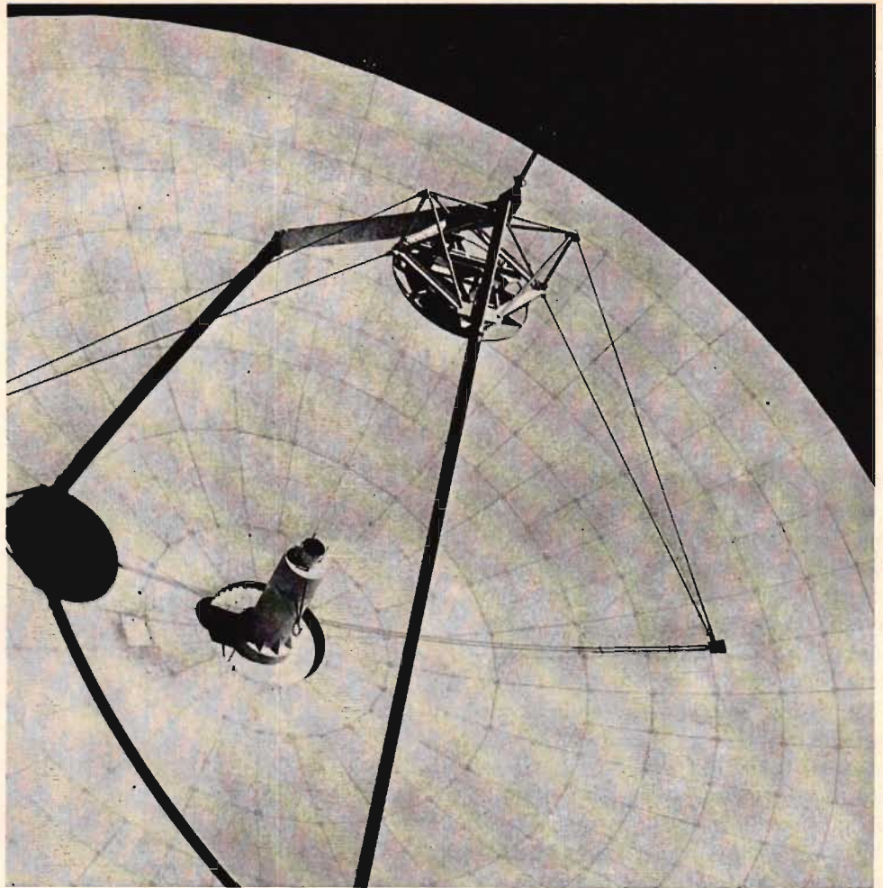
Närbild av Cassegrain-antennen. Lägg märke till de fyra små spårningsantennerna för styrsignalen.
