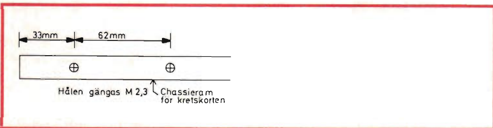
Fig 6. Borrskiss för hålen i VCR-maskinens ram där crispning-kortet skall monteras.
