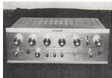
Fig 4. Exteriör av Sony TA-1130 med frontpanelens organ upptagande Sonys speciella ingångsväljare, utförd med två reglage. Den tredje högnivåingången, Aux 3 , syns t.h. medan den snarlika kontakten t.v. är en hörtelefonutgång.
