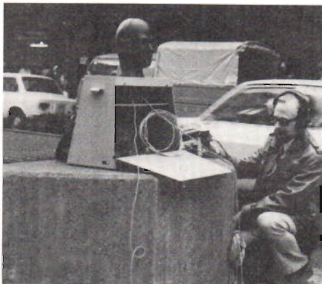
Fig 1. RT skall senare belysa inspelning och resultat med sk konstgjort huvud för binaural stereofoni. Här är Neumann-huvudet uppkopplat på sin plint för upptagning av trafikljud i tre plan, trafiken i sex filer, under jorden T-bana och över huvudet trafikplan under inflygning till Bromma.
