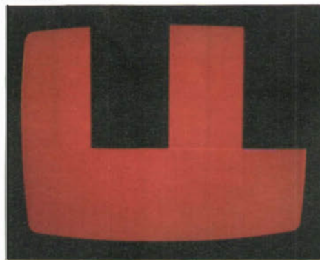
Fig 20 a) Färgbalkar med vitreferens och bortkopplad grön och blå kanon. b) Do men röd och blå bortkopplad. c) Do men röd och grön bortkopplad.
