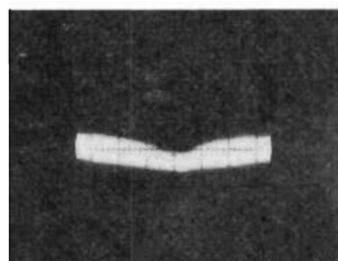
c) 10 kHz, 1 W och X/Y-kopplat oscilloskop. Nivå -10 dB.
