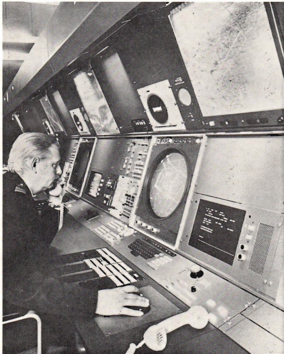
Fig 1. En trafikledarposition i ÖKC. Intressant är att man här också kan få upp digital presentation direkt på PPI. Lösningen på detta heter svepkom-
