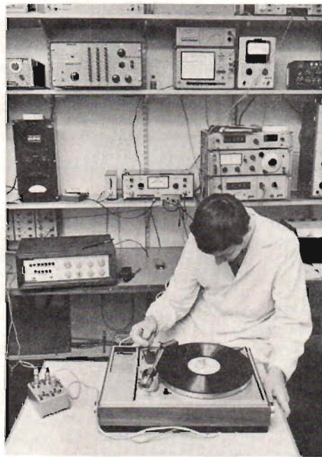
Fig 6. Provningsinteriör. (SP). — På fotot syns ett P-E-verk under test. Förstärkaren i bakgrunden är en CM och i övrigt bl a Brüel & Kjaer mätförstärkare med filter 2606, distorsionsanalysator från Hewlett-Packard, universallräknare, millivoltmetrar från B&K samt Sennheiser med inkopplat vägningsfilter, dämpsatser, oscillatorer, generatorer (en Krohn-Hite syns tv) och frekvensanalysator.
