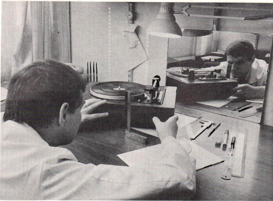
Fig 7. Det förberedande arrangemanget för tonarmmätningarna med hjälp av speglar i olika vinklar enl fig.
