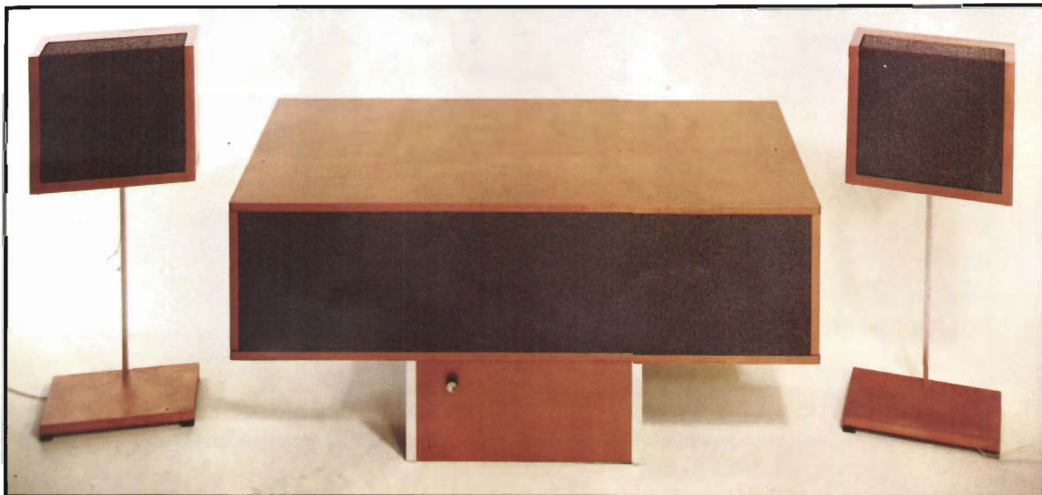
Fig A. RT:s "3D"-system för stereofoni från två mycket lättdrivna sidosystem med måttlig volym samt en gemensam baskanal i form av ett — all verksam volym inräknad — 360 liters exponentialhorn för frekvensområdet ca 25 Hz till omkring 300 Hz. Hornet vilar på ett specialfundament som bidrar till konstruktionens optimering. I funda-
