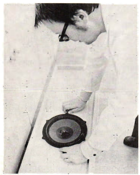
Fig I. Montering ovanifrån av högtalarelement i exponentialhornets första version.
