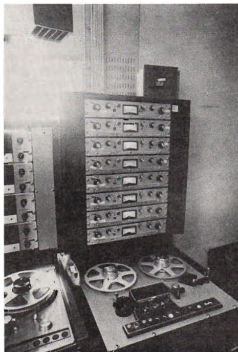
Allt börjar med bandet. Här ett av de verktyg som musikteknikern måste behärska: En 8-kanalig bandspelare (Scully).
