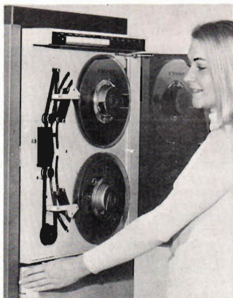
Fig 2. Databandsspelaren TM 100. Lagg märke till bandföringen. Vid vila står armarna för bandsträckningen i sina ändlägen och därmed blir maskinen lätt att ladda.
