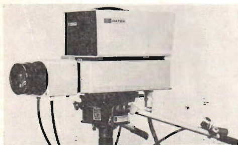
Fig 13. Gates visade en kompakt färgkamera som endast väger 18 kg. TE-201 heter apparaten.
