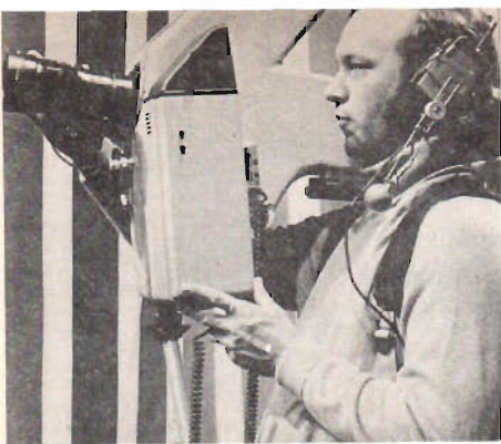
Fig 11. RCA tillverkar en ombyggnadssats till sina kameror TK-44 eller TK 45A för att konvertera dessa till det portabla utförande som visas här.
