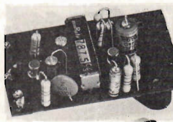
Fig 5. Stämgaflöscillatorn uppbyggd. Det här exemplaret byggdes med tanke på selektivitet i en komradioanläggning, varför plattan "skräddarsyddes" för ett givet utrymme. Därav också frekvensen 787,5 Hz hos gaffeln. Det torde gå att göra oscillatören betydligt mindre.
