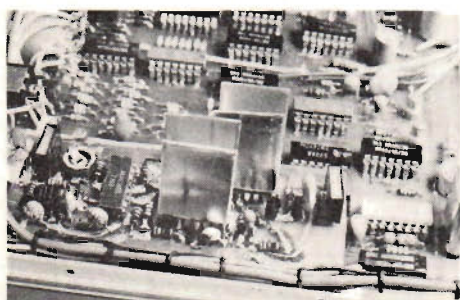
Fig 3. Bilden visar kylflänsarnas montering på IC 502 och 503.
