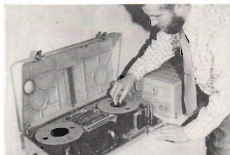
Fig 5. Portabelt videobandspelare, modell TPR-10, fabrikat RCA. Den arbetar med 2"-tape och ger en speltid av 20 min.
