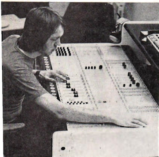
Bilden visar konstruktören Björn Sandlund vid den färdiga ljudprocessorn. Som framgår går det att förse utrustningen med ytterligare plug-in-enheter så att systemet kan byggas ut i framtiden. (Foto: Elektroniknyheter)
