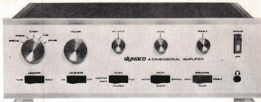
Fig 1. Enkel och sober front uppvisar SCA-80 Q-förstärkaren som alla Dynacos apparater gjort genom tiderna. Den här är så gott som identisk med de gamla 35-förstärkarna och reglage o dyl för tanken till PAS-konstruktionerna samt till PAT-4.
