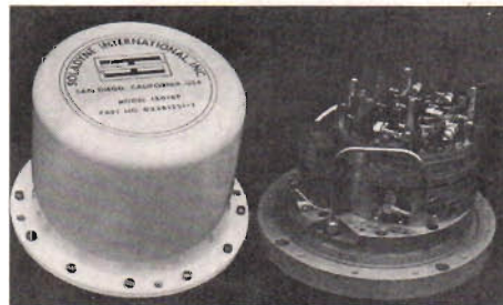
Här visas sändardelen för en mikrovågslänk för 12 GHz från Soladyne. Mottagardelen har samma utseende som sändardelen. De är fästa på parabolens baksida.
