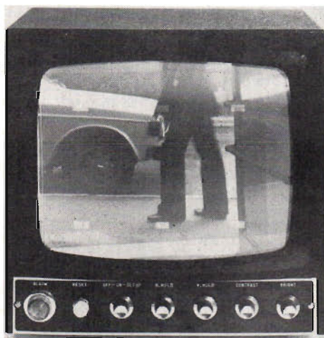
Fig 7. TV-monitor som automatiskt alarmerar vid varje rörelse i bildrutan på de platser som sex flyttbara sensorfält är belägna. (AB Intensa)
