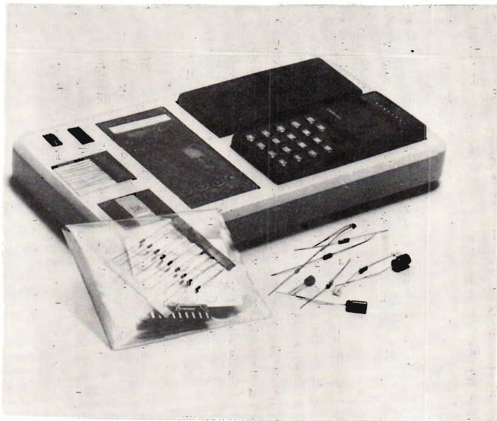
Fig 1. Komponenterna till byggsatsen levereras i denna form. Alla mekaniska detaljer är förarbetade och i stort sett erfordras bara en lödkolv för sammanställningen.
