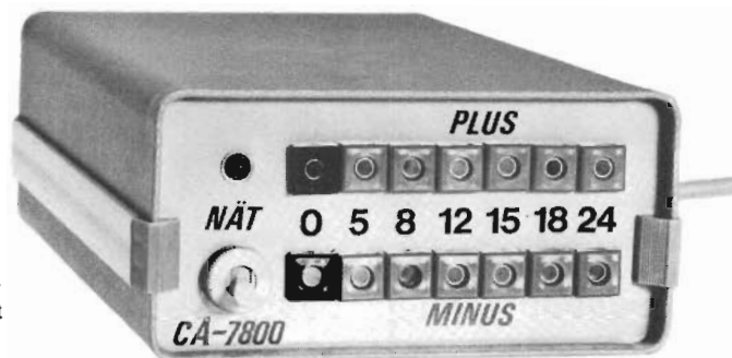
Likspänningsaggregat med fasta spänningar, sex negativa och sex positiva. Principschema för aggregatet visas i fig 1.
