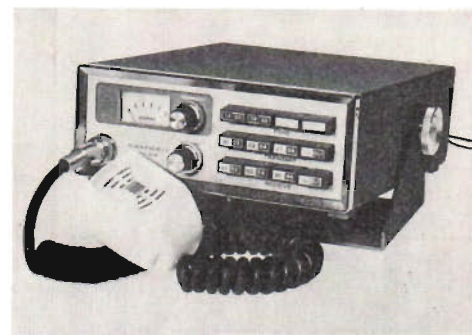
Fig 1. HW-202 färdigbyggd. Den övre raden tangenter hör till tonoscillatorn, vilken inte ingår som standard i byggsatsen utan fås mot tillägg.
