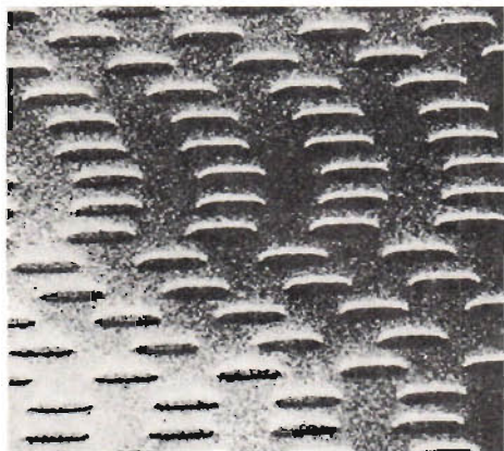
Fig 2. Spårerna i VLP-skivan utgörs av ingraverade fördjupningar med varierande längd, 0,8 \mu\text{m} breda och 0,16 \mu\text{m} djupa. Bilden av skivan är tagen med elektronmikroskop.
