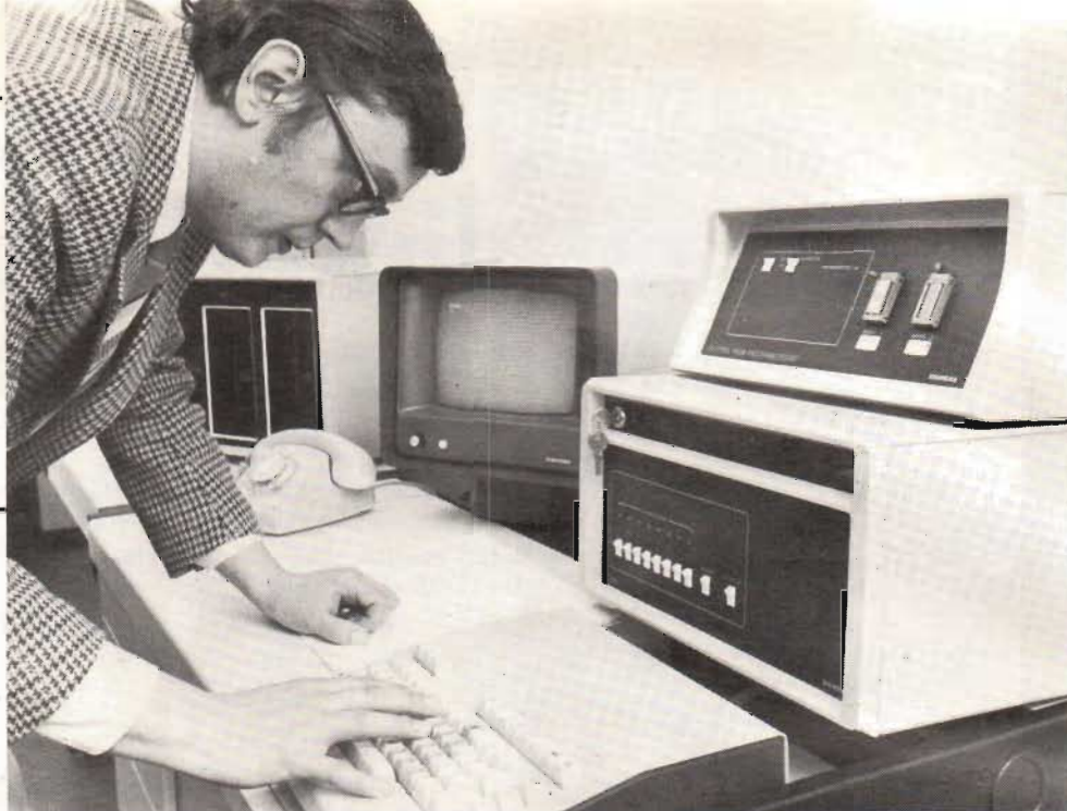
Fig 6. Bilden visar Siemens kompletta programmeringsutrustning med PROM-programmerare, en floppy-disc, inmatningsorgan, datamonitor och modem för anslutning till stordator. Utrustningen kostar ca 100 000 kr.
