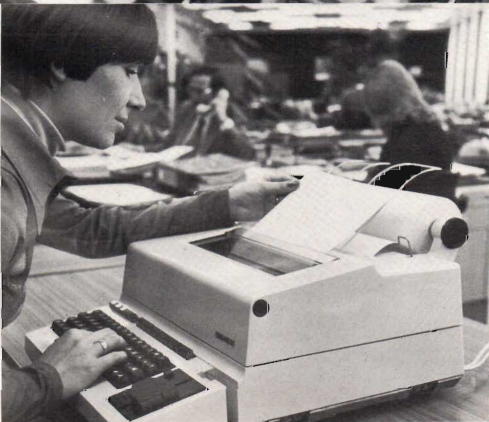
Fig 3. Den nya telexmaskinen är betydligt mindre än och har en ljudnivå som bara är en fjärdedel av sina föregångare. Därmed är T 1000 tystare än många skrivmaskiner.
