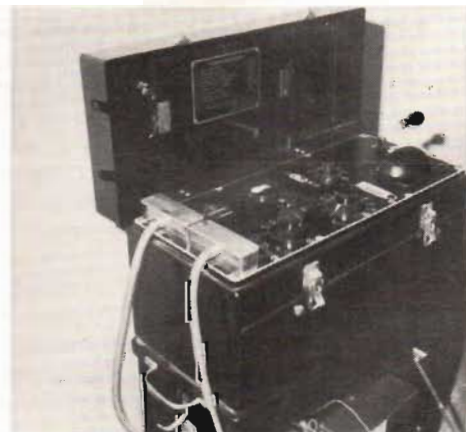
Fig 8. Siemens ekg-apparat med rörförstärkare. Från 1930-talet.
