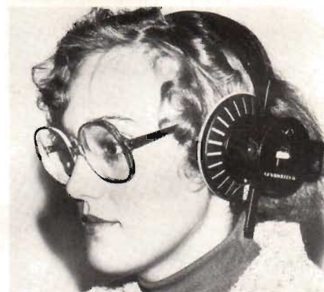
Fig 7. Hörtelefoner med mottagande fotodioder. De ingår liksom sändarutrustningen i fig 6 i Sennheisers stereoöverföringssystem.
