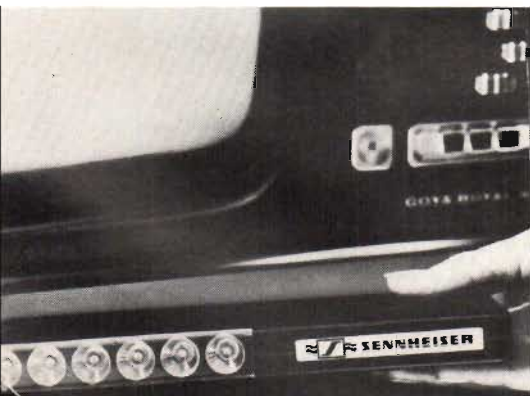
Fig 3. Sennheisers IR-sändare SI 406. Den är avsedd för överföring av enkanaligt TV-ljud till hörtelefoner.
