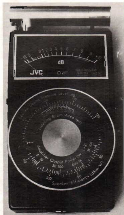
Fig 2. Framsidan på ljudnivåmätaren domineras av en cirkulär "räknesticka" för akustiska beräkningar. Märk den vilande mikrofonarmen överst. Mätdonet aktiveras när armen förs ut i mätposition.
