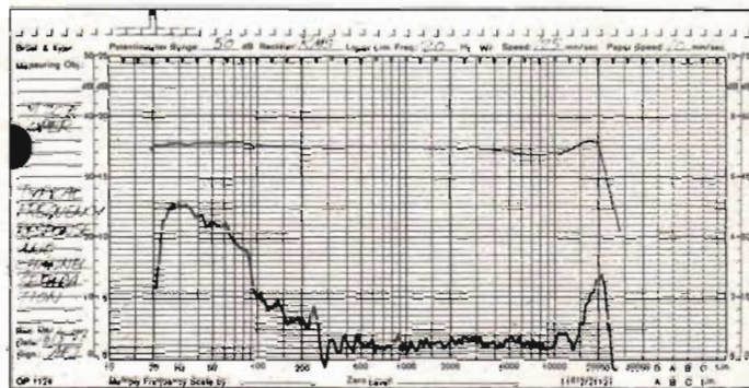
Fig 6. Typisk frekvens- och separationskurva för M 20 FI Super, sådan Ortofon anger den.
