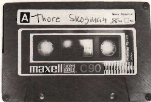
Fig 6 och 7. Maxell använder ett extravagant system för identifiering. Vid leverans finns bokstav i relief, A resp B, på vardera sidan. I kassettlådan följer med ett antal självhäftande lappar, också de med bokstäverna A och B förtryckta. På dem får man alltså skriva sina musiktitlar etc.
