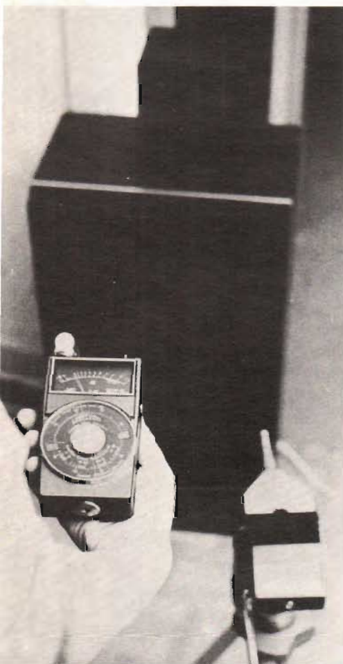
Fig 1. LM-5 i användning. Vi mätte på ett högkvalitativt högtalarsystem och jämförde resultaten i samma rum och mätposition med B & K ljudnivåmätare 2206.
