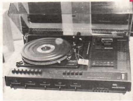
Fig 8. Programmerbara skivspelaren Accutrac 4000. På manöverbordet längst fram kan man programmera för spel av skivans band i godtycklig ordning.
