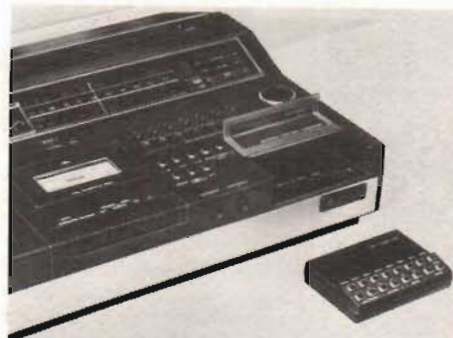
Fig 10. En av de totalmodulerade anläggningar- na i Telefunktens program. Denna modell HR 5000 digital är bl a försedd med frekvenssynthes i FM-tu- nerna.
