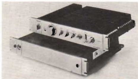
Fig 15. Pulsbreddmodulerade för- och slutsteg från Sony tilldrog sig stor uppmärksamhet.
