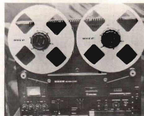
Fig 7. Uher SG 630 Logic med fyra motorer och omegabandföring.
