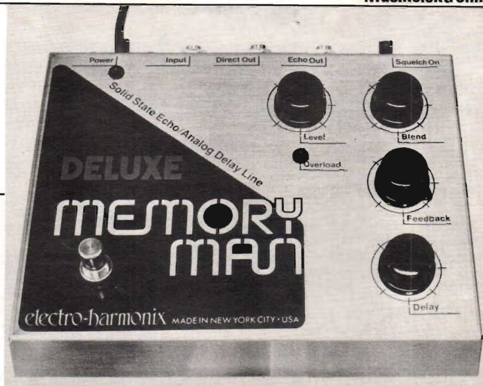
Fig visar en av de många tillsatsboxar som Electro Harmonix, USA, tillverkar: Memory Man. Denna består av ett antal fördröjningsledningar som kan ge eko- och efterklangseffekter.
