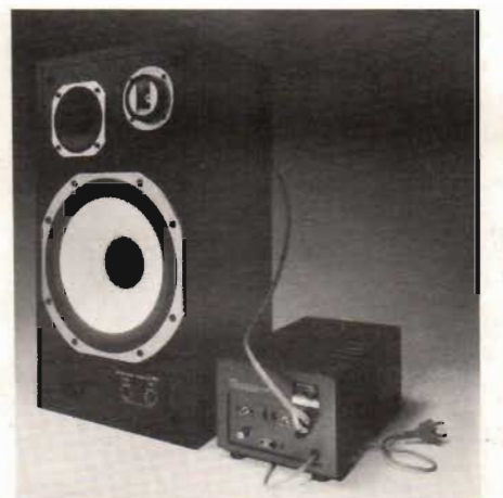
Fig 2. Av fotot framgår däremot lite av en bärande idé bakom Kenwoods L-serie: Den i sammanhang et väsentliga förläggningen av effekt delen nära intill högtalaren, där en specialkabel förbinder förstärkare — ljudkälla. Märk kabelns utformning med en uppbyggd av en hel mängd ledare i gemensamt hölje. Se texten.
