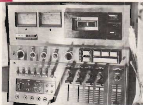
Fig 3. Som en absolut nyhet kan man beteckna denna kassettspelare A 860 från Teac. Den kan med den inbyggda dBx-elektroniken prestera 80 dB dynamik!
