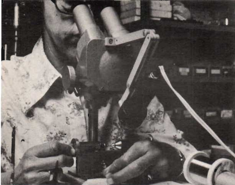
Fig 9. Här ses ett par viktiga moment i Ortofons pick up-tillverkning: Den ytterst precisionskrävande, maskinella lindningen av de små spolarna, vilket sker under mikroskop, samt kontroll av utspänning, kanalseparation och ett antal andra parametrar efter det det elektriska monteraget förenats med höljet
