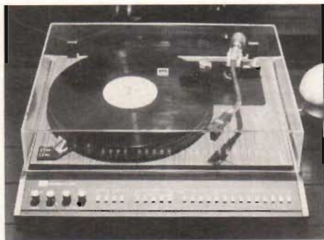
Fig 8. Programmerbara skivspelaren Accutrac 4000. På manöverbordet längst fram kan man programmera för spel av skivans band i godtycklig ordning.
