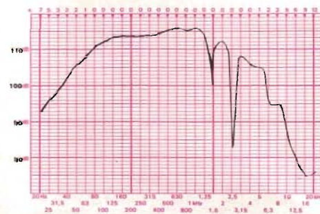
Fig 12. Traynor 12" har pappdom och vägpressad kon. Z_{nom} = 9 ohm, R = 6,5 ohm. Z/R = 1,23 .
