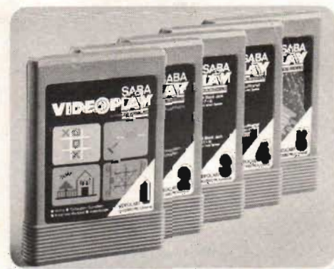
Fig 2. Spelprogrammen finns lagrade i ROM (läsminnen) som ligger i de kassetter som visas på bilden. En kassett kan innehålla upp till 4 olika program.
