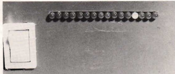
Fig 18. Om bandspelaren går före projektorn kommer den lysande punkten att flyttas åt höger.
