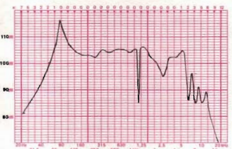
Fig 14. Säreigna, numera nedlagda, Yamaha JA 4001 hade en fast inspänd tjockväggig kon. Z_{nom} = 8 \text{ ohm} , R = 5,8 \text{ ohm} . Z/R = 1,38 . Lägga märke till den tydliga resonansen i basen.
