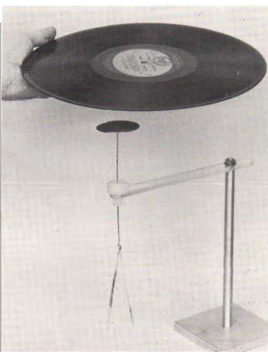
Fig 3. På denna bild från ett laboratorium hos 3 M ser vi hur en laddad skiva påverkar elektro-skopet nederst.
