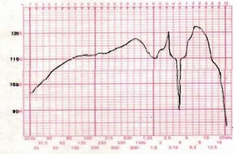
Fig 8. Philips 12100 M 4. Keramisk magnet. Kon och diskantspridare (dubbelkonutförande) av papp. Nätdom Z_{nom} = 4 ohm. R = 3,2 ohm. Z/R = 1,25 . Storlek = 316 mm.
