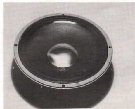
Fig 5. Elementet JBL K 120 kan fås monterat i Fender Twin Reverb (Svensk representant: Musikantor & Co AB, Mölndal). Pappkon med "dopad" kant och metallom. Z_{nom} = 8 ohm, R = 5,3 ohm. Z/R = 1,51 . Storlek 12".
