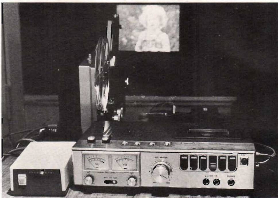
Fig 1. Synkanläggningen i full verksamhet med projektor, kassettspelare och synkronisator.
