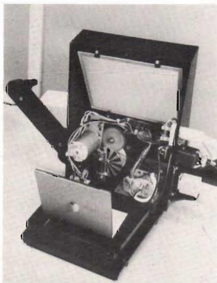
Fig 23. Modifierad redigeringsapparat Prestinox S8. Lagg märke till skivan med de 12 svarta fälten.
