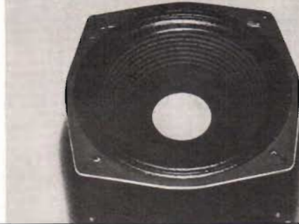
Fig 4. HH PL 50 är ett element, vars kon är vågpressad i ytterdelen. Z_{nom} = 8 ohm, R = 5,6 ohm. Z/R = 1,43 . Elementet har nåtdom. Storlek 12".
