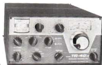
Drake TR-4CW Sändare, mottagare SSB-AMCW 3,5-29,0 MHz 300 W P.E.P. vid SSB 260 W P.E.P. vid CW 260 W P.E.P. vid AM (modulationsstopp) 50 W AM med bärvåg
