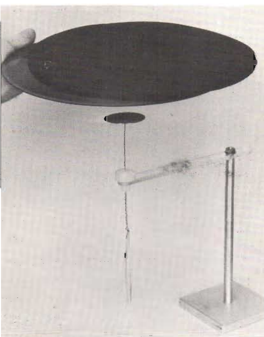
Fig 4. Med materialet "Dustguard" anbragt ovanpå skivan reduceras laddningen så att inget utslag kan avläsas, allt enligt 3 M.
