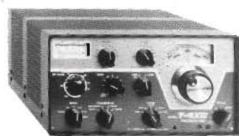
Drake T-4XC. SSB sändare Frekvensområde: 3,5-29 MHz 200 W P.E.P.
