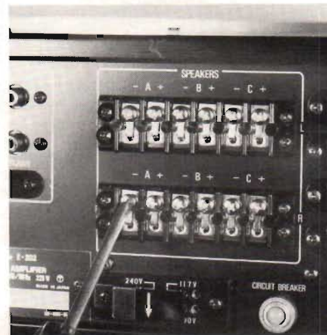
Fig 4. Så här skall det väl ändå inte behöva vara – specialmejsel för att få in högtalarkablarna och tröga små bleck att skruva ut för infästning av avisolerad koppartråd. En avig och svårarbetad installation.
