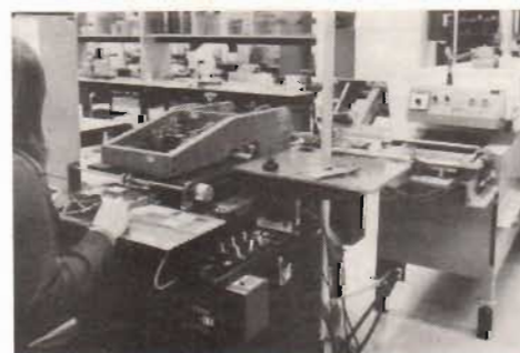
Fig 5. I denna automatiska tryckmaskin pålaggs pastor på substratet t.e. med stencilen i fig 4.
