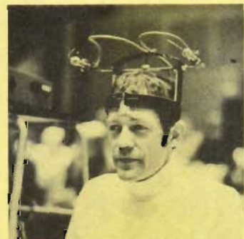
Så här ser Aachen-skallen ut, buren under reella förhållanden, som Karl-Otto Valentin demonstrerar. Mikrofonhöjd i förhållande till öra saknar betydelse. Men här har inte kapseltillledarna letts in i bärarens öron, märk väl.
