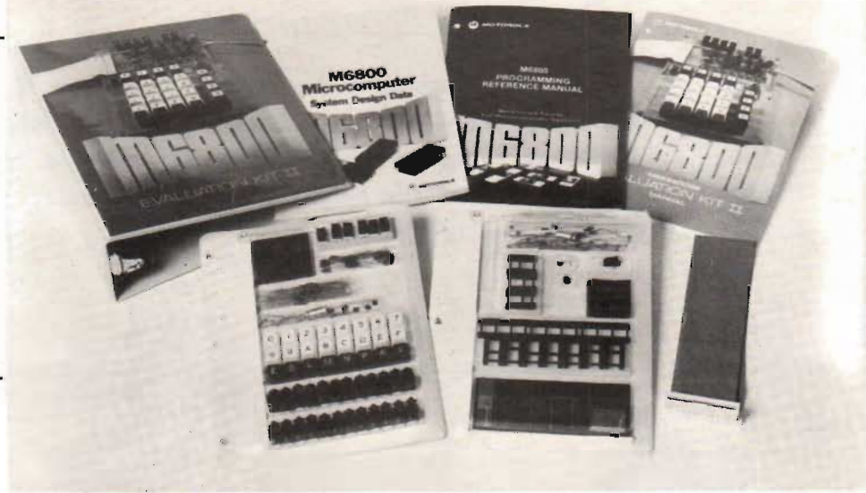
Fig 6. Evaluation kit II tillverkas av Motorola och innehåller M6800. Systemet är expanderbart och ROM, RAM och anpassningskretsar kan adderas. Maskinprogram kan matas in via tangentbordet på kortet eller från det inbyggda kassetterfacet. Man kan genom val av ROM arbeta med språk som JBUG, Minibug II eller III. De två senare kan användas för anpassning till RS-232-standarder eller TTY-terminaler.
