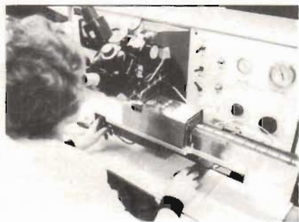
Fig 8. Här monteras en halv ledarbricka genom termokompression.
