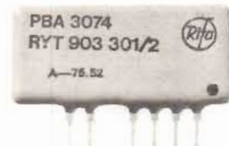
Fig 1. I den nya elektroniska telefonen Ericofon 700 ingår bl a tre hybridkretsar som samtidigt är ett exempel på olika kapslingstekniker: Epoxydoppad (PBA 3074), epoxyfylld med A1-skydd (PBA 3075) och plastgjuten (PBA 3076).
