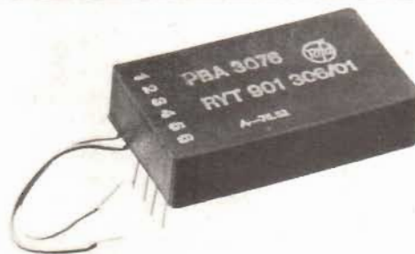
Fig 1. I den nya elektroniska telefonen Ericofon 700 ingår bl a tre hybridkretsar som samtidigt är ett exempel på olika kapslingstekniker: Epoxydoppad (PBA 3074), epoxyfylld med A1-skydd (PBA 3075) och plastgjuten (PBA 3076).
