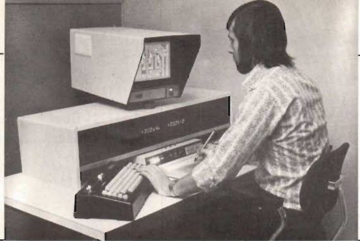
b) Ritningen databehandlas och fotomaskerna framställs sedan med en grafisk databehandlingsenhet.
