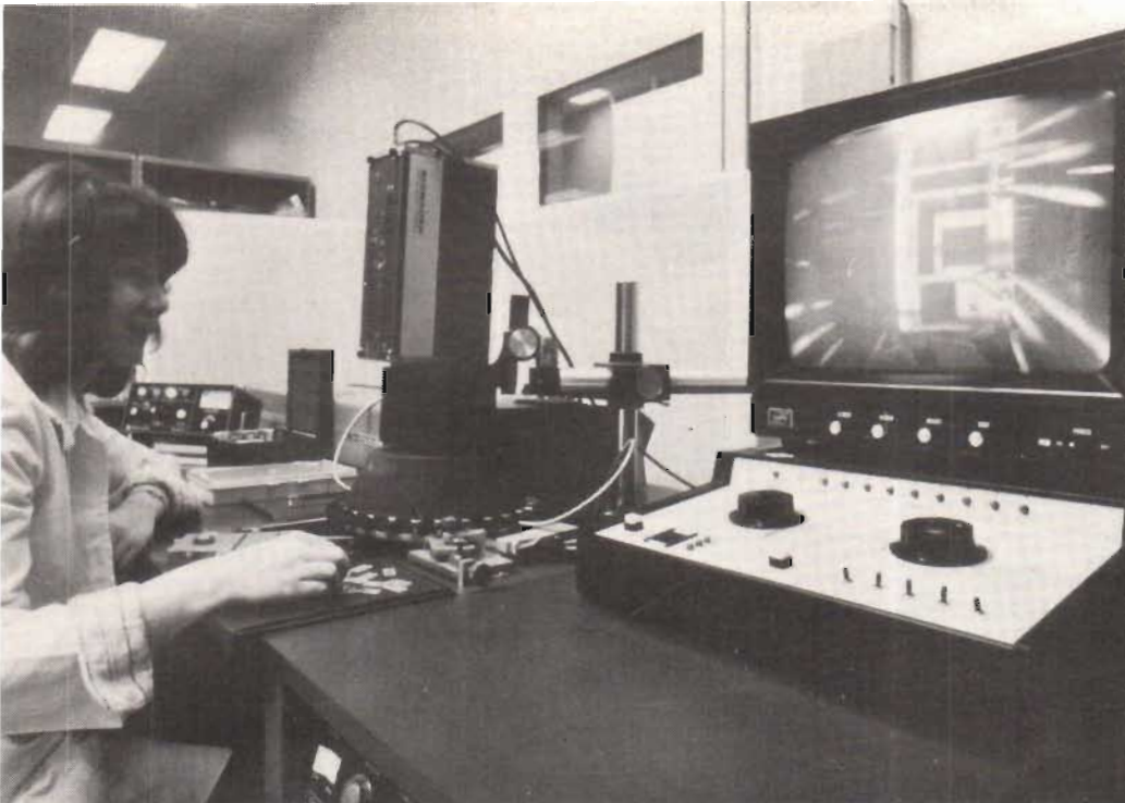
Fig 7. Lasertrimning av motstånden sker automatiskt.
