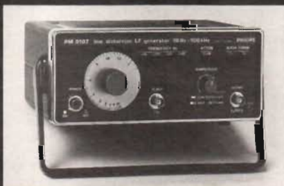
PM 5107 LF-generator 10 Hz – 100 kHz. 2 V RMS sinus/4 V fyrkant. 0,02 % distorsion. Separat TTL-utgång.
