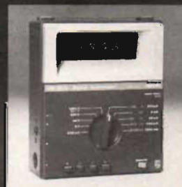
PM 2513A digital multimeter 0,2 V – 1 kV DC/600 V AC. 0,2 mA – 2 A DC/AC. 200 ohm – 2 Mohm. Temperaturmätning –60°C – +200°C
