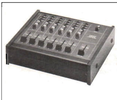
Model 2. Liten studiomixer för den avancerade amatören. 6 ingångar samt 4 utgångar. Passiva tonkontroller, utläggningsomkopplare med panoreringspotentiometer, buss in-funktion och tillgång till signal för yttre signalbehandling. Dynamikomfånget är bättre än 72 dB vid användande av en ingång och bättre än 65 dB vid alla 6 ingångarna. Mått: 34×10×31 cm.
