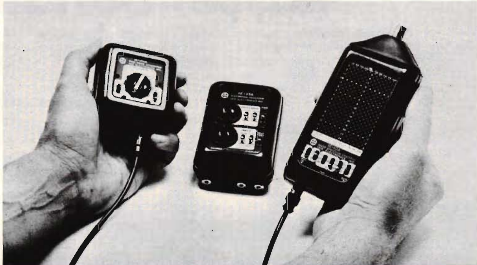
Fig b. Här är de tre Ivie-enheter samlade: Fr v brusgeneratoren IE-20 A, distorsionsanalysatorn/oscillatorn IE-15 A och analysatorn för ljudspektrum IE-19 A. Alla är enligt RT:s erfarenhet både tillförlitliga och tåliga, d v s de verkar kunna utstå relativt vårdslös behandling ganska väl. Totalt kostar en komplett uppsättning instrument plus tillbehör ca 5 000 kr exkl moms.
