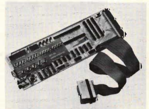
Fig 8. Med denna "single stepper" kan man stega igenom sitt program. Testinstrumentet är avpassat för alla 6 800-baserade mikrodatorer och tillverkas av Telefrang AB . Enheten heter B2 , kostar 3 500 kr och marknadsförs genom Zetner AB .
