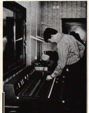
Den här bilden visar ett av de fasta mixerbord som finns i kontrollrummen.
