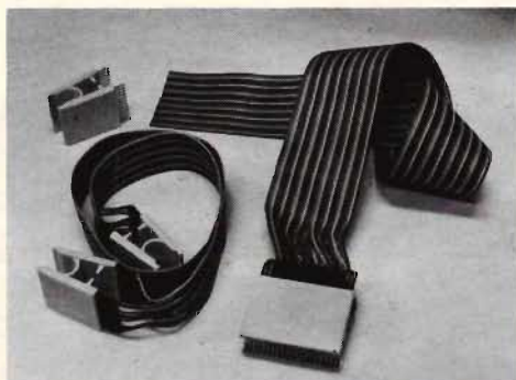
Fig 4. Här visas några kontaktidon från CSC som är avsedda att användas vid service och felsökning på digitala kretsar.
