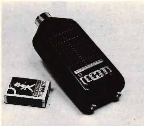
Fig a. Ivies spektrumanalysator är en högst kapabel och noggrann sådan, trots de sensationellt små dimensionerna, den återfinns i dag i många sammanhang – speciellt för rumsakustiska inmätningar, för service på estradljudanläggningar, som studioverktyg för ljudtrycksmätningar i kontrollrum, för bullermätningar utomhus eller i t ex industrimiljö. Intensitet och karaktär hos bullret avläses snabbt.
