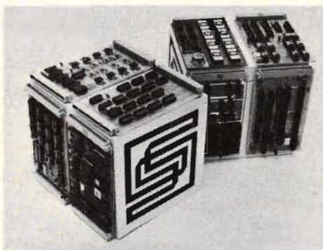
Fig 5. Bilden illustrerar det smarta och mångsidiga kortsystemet från Sattco , i vilket valfri processor kan användas.
