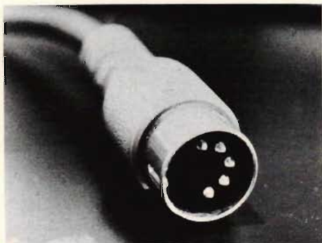
Fig 4. Den sammansatta kontakten bjuder på hög komfort: Endast ett don behöver sättas i och dras ur. Dessutom får man gynnsam jordanslutning i blott en punkt.
