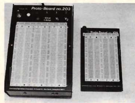
Fig 3. Proto-Board 203 är en intressant variant. Överst ser vi en experimentplatta med 2 250 anslutningspunkter, men under den ligger ett nättaggregat för +5 V för matning av kretsarna. En utbyggd variant, PB 203A, har även ±15 V stabiliserad matningsspänning för drivning av exempelvis operationsförstärkare.
