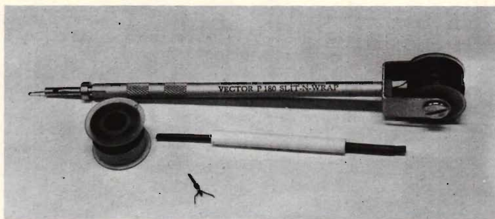
Fig 5. Virpennan Vector 180 P slit-n-wrap lämpar sig utmärkt vid virförbindningar på prototypkort eller experimentkopplingar.
