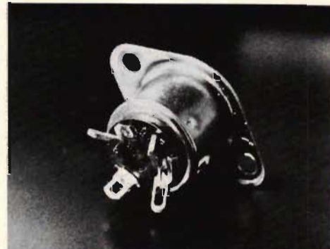
Fig 6. Den 5-poliga chassikontakten är vanligast på europeisk apparatur och bjuder även den på en del finmekaniskt pyssel vid inkopplingen.
