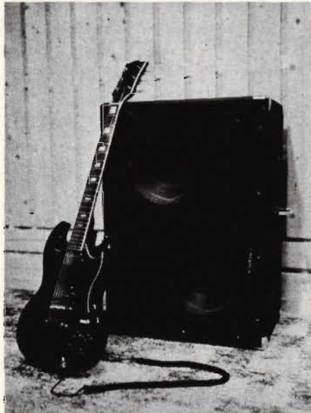
Fig 9. Det i texten omtalade system 16 visas på bilden. I detta ingår två element av typen Philips AD 12100 G8H. De ursprungliga diskant högtalarna (4 st AD 0162/T8) har tagits bort eftersom dessa inte behövs för ändamålet.
