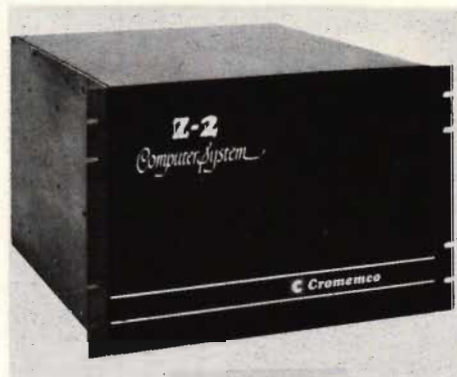
Fig 7. Cromenco Z2 är en mikroprocessor som följer S-100 -bussen. Den är därmed klart lämplig i hobby-sammanhang men är även kvalificerad nog att användas i industriella sammanhang. Processor är Z 80 .
