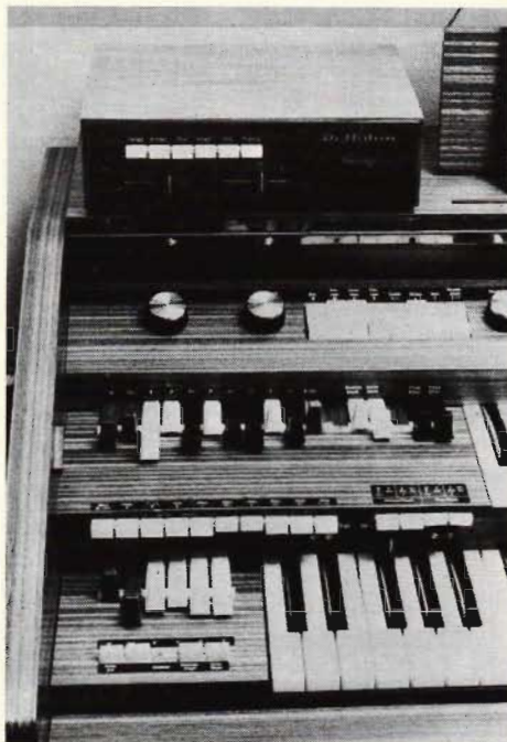
Fig 1. Orgeln med några av tillsatsernas manöverdon. Dragreglarna för över- och undermanualen framgår samt väljaren för footlägen till specialeffekterna. Ovanpå orgeln står faszvibratet.
