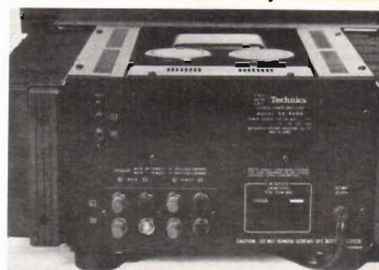
Fig 5. Slutstegets bakre panel. Att en polskruv kan ses avslagen hänför sig till ett transportmissöde under en demonstrationsturné. Hela kontaktplattan är utbytt. Högtalaranslutningar med skruvad kabel. Märk de rejäla gummiklossarna och baksidans "bulkar" av gummi, som förstärkaren kan vila på stående.
