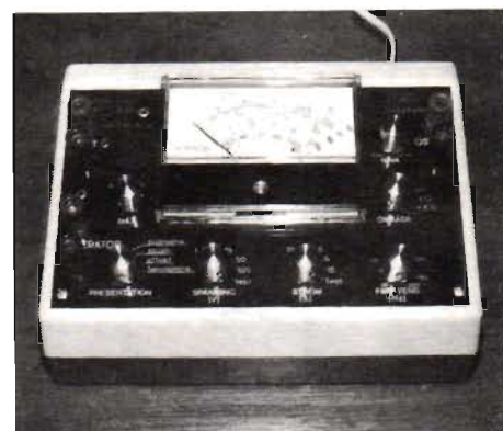
Fig 1. I färdigt skick kan instrumentet ta sig ut på detta vis med ingångskontakter från förstärkaren och utgångar till högtalaren längst tv. Längst upp i h ses oscillatorutgången och i mitten det dominerande visarinstrumentet.
