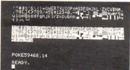
Fig 4. Efter ett specialkommando byts skifttecknen på bokstavstangenterna ut mot gemena bokstavstyper.
