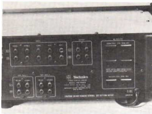
Fig 3. Den spaciösa ytan över förstärkarens bakre panel ger utmärkt plats för också stora kontakter till anslutningarna. Uttagen t h är förstås igenlagda i Sverige. Av fotot framgår inte hur dekorerat "topplocket" är med scheman och kopplingsexempel.
