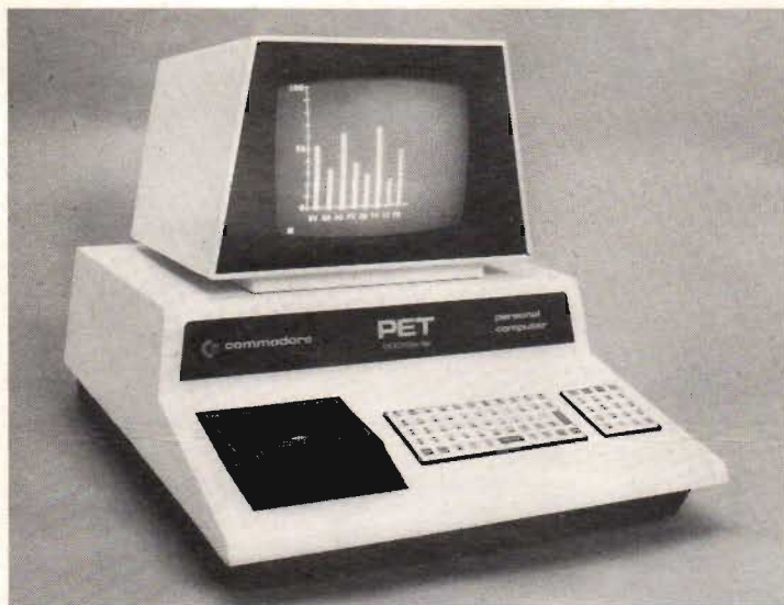
Fig 1. Minidatorn med kassettspelaren tv på manöverbordet och bildskärmsdelen överst. På skärmen visas ett exempel på grafisk presentation.
