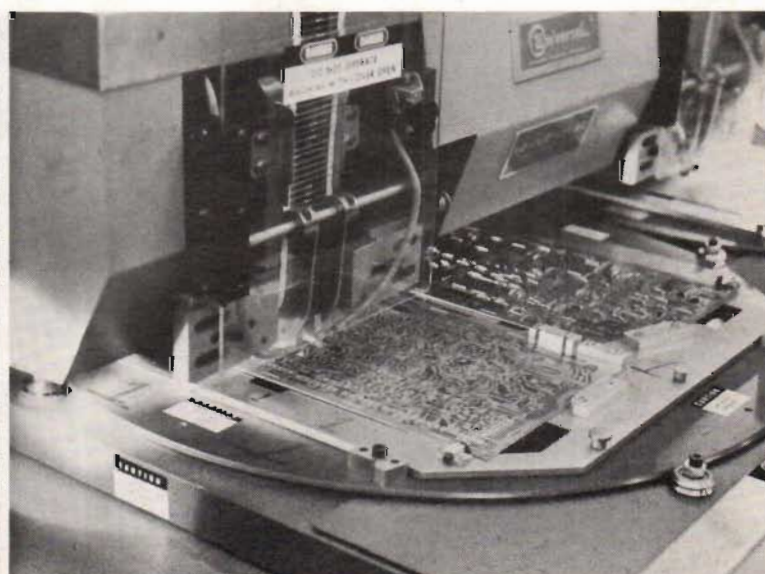
Fig 2. Delvis sker monteringen med datorstyrda automater. Här monterar mindre, passiva komponenter.
