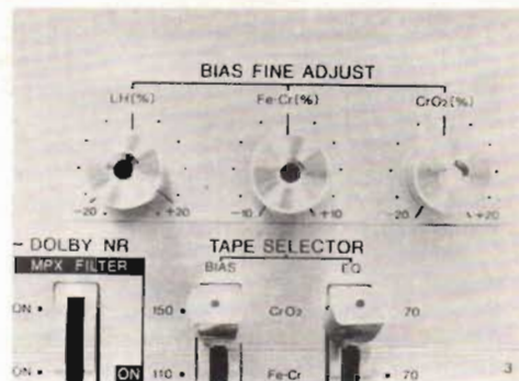
Fig 3. Förmagnetiseringen kan finjusteras för olika bandtyper. En lampa i centrum av respektive reglage visar vilken bandtyp som är vald och därmed vilken ratt som är aktiv.
