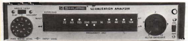
Fig 5. Med största känsligheten, dvs minsta toleransgränsen 2 dB, ligger blott referensoktaven inom gränsen. Observera att vi mäter på ett korrigerat system!
