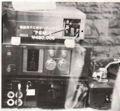
Fig 1. Flera Japanfirmor erbjuder från 1978 digital-apparatur för hem-Hifi, ehuru systemlösningarna skiftar. Man använder såväl VCR-maskiner som videobandspelare eller speciell kassettdapparatur som här t ex en U-Mati ihop med Sonys PCM-1, pris 480 000 yen i Japan. Frekvensgång från 2 Hz till 20 kHz inom 1 dB. Systemet är pulskodmodulerat. Sony erbjuder också Betamax-videospelaren som tonfrekvensmedium i systemet.
