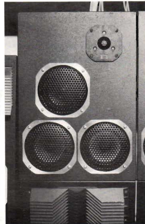
(6) "Sinus"-systemet har framtagits för att bli ett budgetsystem men är för den skull inte ett sämre alternativ utan har vid de jämförande testerna fått omdömet "bra" och ibland "bland de bästa" för flertalet spelade musikstilar. Mellanregisterelementet är Sinus MQ 5298 IQ och diskantelementet TQ 2592 XX. Det senare elementet skulle även kunna ersättas av Philips AD 0163, Peerless LK 10 eller Peerless KO 10 DT, då dessa har en tämligen väl överensstämmande ljudkaraktär. Här bör dock ses upp vid konstruktion av det passiva filtret, då dess impedanskurvor ej överensstämmer. (Pris för elementen ca 365 kr.)
