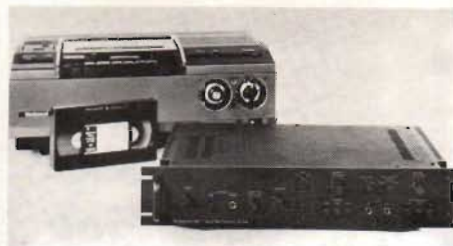
Fig A. Här är Technics från JVC övertagna VHS-PCM-system med sitt förstärkeri de - 20 kHz inom 0,5 dB, alltså en kassettlösning av det slag som nu ganska många japanska fabrikanter erbjuder för digitalljud. S/n anges till 85 dB.
