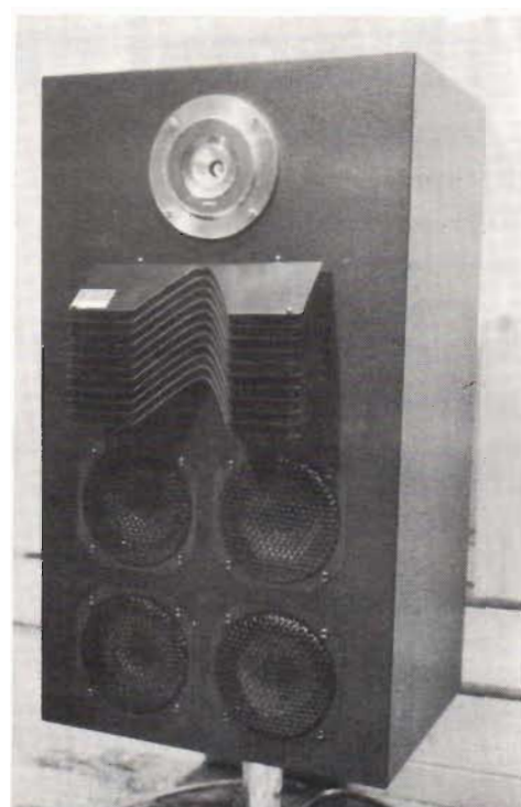
(9) "Det stora Coral"-systemet är gjort med samma premisser som för system (8) och ligger även prismässigt i ungefär samma nivå. Det består av Coralelementen H 100 för diskanten, drivelementet M 100, mellanregisterhornet AH 503 med spridare AL 603 och fyra Sinus FQ 5294 FX. (Pris för elementen ca 3 800 kr.)
