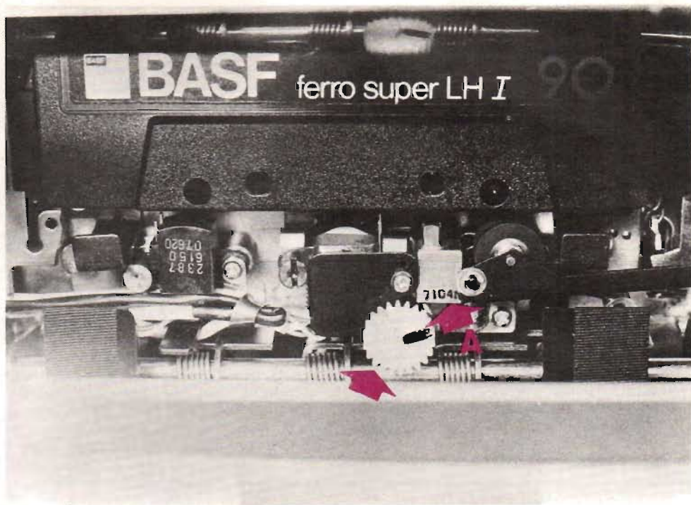
Fig 4. Närbild av bandtransporten. Vid A syns det extra avspelningshuvudet för justering av förmagnetiseringsringen. Kugghjulet vid B ingår i anordningen för justering av kontrollhuvudets azimut.
