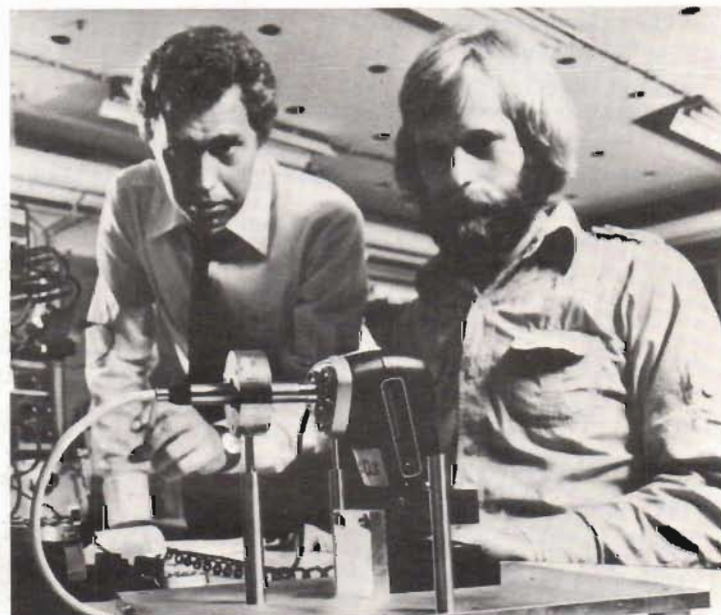
◀ Fig 3. I det ekofria rummet mäter man bullret från exempelvis hushållsapparater, här en dammsugare. Specialformade block av absorberande material är inbyggda i golv, väggar och tak.
