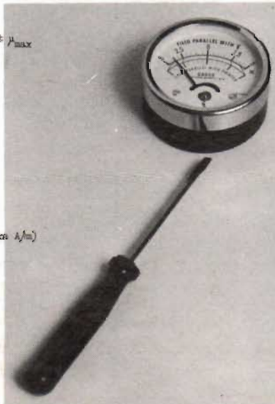
Fig 2. Magnetometern reagerar här för en magnetiserad skrivmejsel. De känsligaste typerna av magnetometrar från Annis ger maxutslag för 0,5 G och medger därmed noggranna mätningar av det jordmagnetiska fältet.
