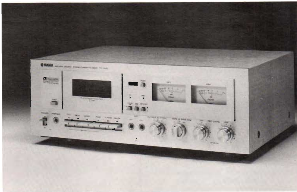
Fig a. Exteriören av Yamahas nya kassettdäck TC 1000. Denna 2-motorförsedda maskin har flera påkostade detaljer som t ex varierbar tonhöjdsstyrka, toppspänningsmetrar, omställbar yttre förmagnetisering för olika bandtyper, minneskrets och alltså den nya tonhuvudlösningen som ger mycket hög dynamik och fördelaktiga magnetiska egenskaper. "Pure" och "Plasma" står det på kassettschuktets lucka. — Motorn arbetar med fas-låsningsskretsar (PLL-teknik) och V-FET i inspelningsförstärkaren, som är differentialkopplad.
