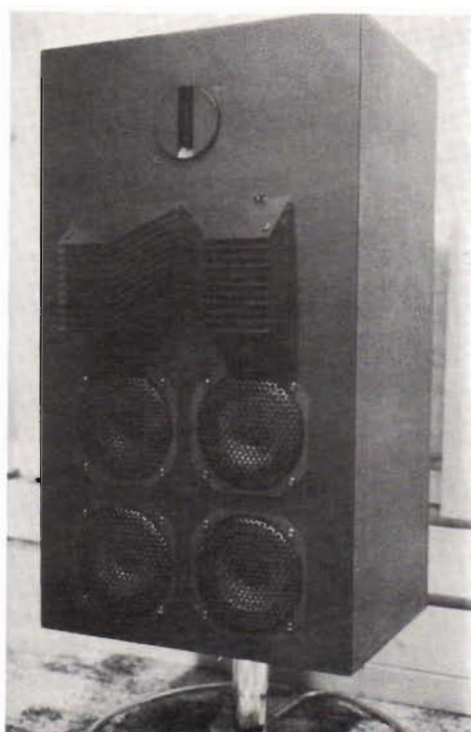
(8) "JBL"-3-vägssystemet är framtaget direkt med tanke på de Hi fi-entusiaster som är villiga att betala för de dyra element, vilka måste till för att nå upp i "den översta klassen" av välljud. I systemet ingår JBL-elementen 077, hornet 2307, drivelement 2410, linsen 2308 och fyra Sinus FQ 5294 FX eller en JBL 2110/D208. (Pris för elementen ca 4 000 kr.)
