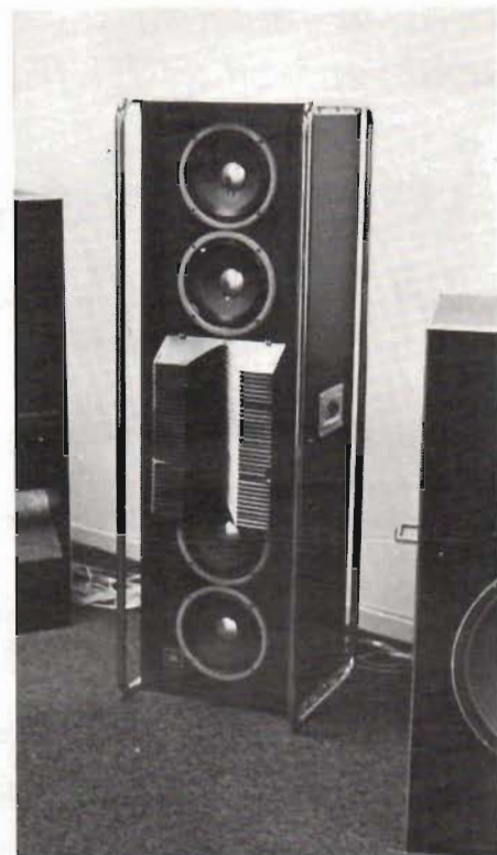
Fig 2. Denna kombination är gjord för PA-bruk och innehåller fyra bredbandselement 2110 och i mitten bakom diskantspridarna sitter två element för det högre registret: 2105. Märk den stabila rörramen som skyddar elementen effektivt vid transport. Anordningen är patentsökt.
