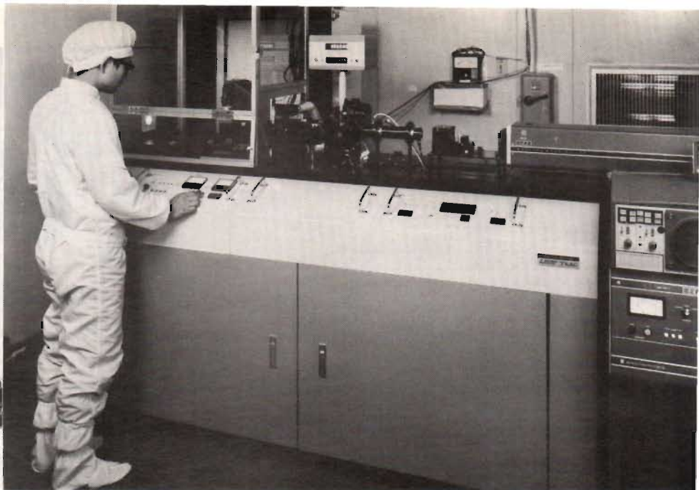
Fig b. Miljö- och omgivningskraven är hårda vid de olika framställningsleden för ljudlaser-skivan. Här ses själva laserinkodningsapparaturen – fotot taget i Mitsubishis testlabb – med argonlasern synlig i höljet i h ovanför "scopet". Märk glasbursinkapslingen av digitalsignalbäraren/skivan. Fö finns bandmaskiner klara nu som uppges urbeta med fasta tonhuvuden i st f roterande.
