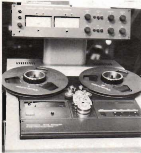
Fig 2. Ett antal firmor har konverterat sina vanliga analoga bandspelare till att göra informationsbärare med pulskodmodulerings teknik – här Technics 1500 lagd i konsolstativ och försedd med pcm-elektronik för två kanaler. Matsushita experimenterar också med mångkanalmaskiner för pcm.
