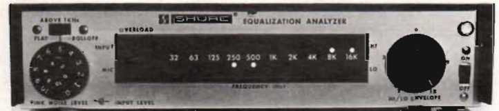
Fig 1. Shureanalysatorn under mätning. Med mätområdesväljaren till höger har här valts en tolerans på 12 dB, och vi ser att några frekvenser faller utanför gränsen redan vid detta stora område. De släckta lysdiöterna indikerar att värdet vid de frekvenserna ligger inom 12 dB.
