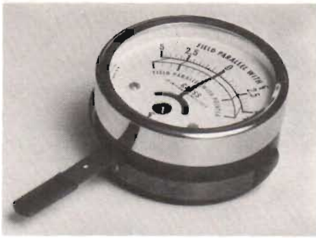
Fig 3. Med en speciell mjukjärnsprob kan man göra mätningar på svåråtkomliga ställen.
