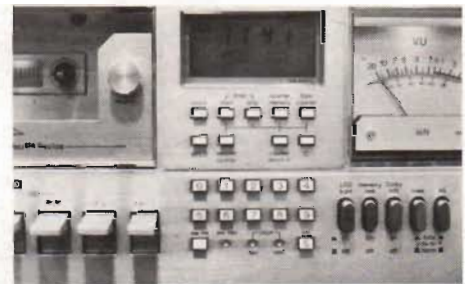
Fig 5. Här en detaljbild av "panelen" till 3150: Kvartsur med 24-timmarsvisning och programövervakning för automatisk inspelning. Fallerar nätet, kan automatiken slå in batteridrift! Mikrodatorn kan ge förutbestämd in- och avspelning, stopp, etc. Den jobbar ihop med APLD-nätet i apparaten som ger automatisk sökning med kapaciteten "19 songs ahead", dvs 19 inslag framåt på tapen, letar upp önskat ställe och spelar upp det. Det går också att synka ihop automatiken med bandräkneverket, så att önskat bandvarv letas fram. Givetvis också minne för återspolningen... nollställning på godtyckligt ställe minnescalls för ny start därifrån pu önskan. En viss del av tapen kan även fås uppspelad. Mikroprocessorns bitkapacitet meddelas inte, men datorn måste till då APLD bara känner av själva tomrummen mellan bandslagen och alltså inte fungerar på kontinuerlig bandning. Räkneverksfunktionerna i Optonic är elektriska och inte mekaniska – det finns två stycken fö och de "minns" olika uppgifter i tid, inspelning och bandgång. Redigeringsblocket på Optonic ger bl a en komplettering till APLD-automatiken. Trycker man ned Edit-tangenten, uppstår en bit blanktape som underlättar senare sökning.
