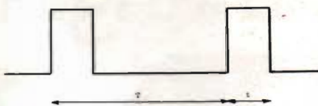
Fig 2. Genom att variera pulsförhållandet T/t i ett pulståg har vi undersökt hur utstyrningsinstrumenten reagerar för olika kursformer.
