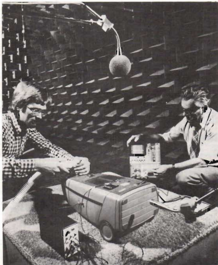
◀ Fig 3. I det ekofria rummet mäter man bullret från exempelvis hushållsapparater, här en dammsugare. Specialformade block av absorberande material är inbyggda i golv, väggar och tak.
