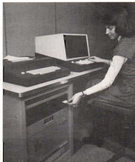
Fig 3. Ett prisbilligt system för bearbetning av meddelanden tillverkas av Sperry och heter SCAMP-X . Det är tillverkat för kommersiella användare och visades för första gången under utställningen. Standardutförandet kan programmeras för många användningsområden vilket omfattar bearbetning av officiella telexmeddelanden, lagring och växling, formattering av meddelandepuppställning och textinnehåll.
