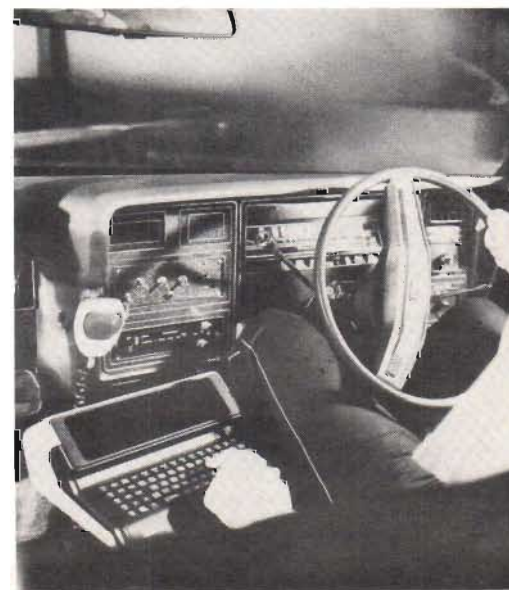
Fig 2. Denna terminal, Motorola Modat, gör det möjligt för mobila användare att få direktförbindning med datorer via radioöverföring.
