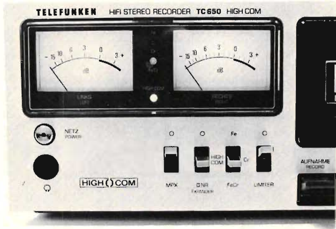
Fig 1. Här återges en del av manöverpanelen med den unika omkopplaren för High Com. Systemet tillåter även avspelning av kassetter som spelats in med Dolby.
