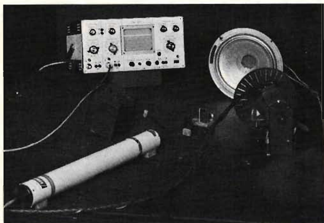
Fig 5. Laserholografi har använts i årtal av den brittiska fabriken för studium av membran under drivbetingelser över hela tonspekt-rum, med vilken metod olineariteter och distorsionsuppkomst kan härledas.
