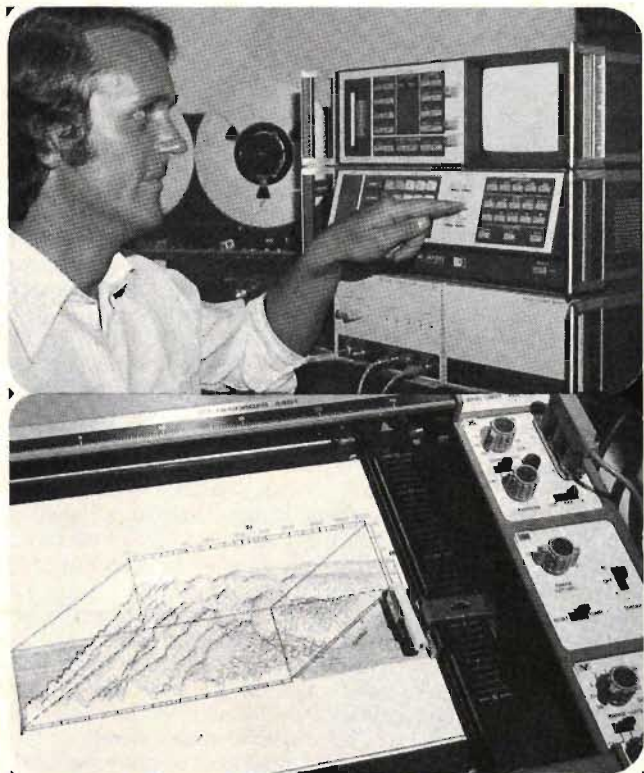
Allt är ingalunda av egen konstruktion i Wharfedales akustiklabb – här ses dr Fryer vid en H-P-analysator med tillhörande dator. Men onekligen är hans, och för fysiker mycket typiska, metoder med selektiva insatser snarare än generella intressantare. – Undertill skymtar just en sådan "hemlagad" lösning för tredimensionell akustisk analys; ett egenbyggt instrument för x/y-plotting av högtalarkarakteristik under olika betingelser.
