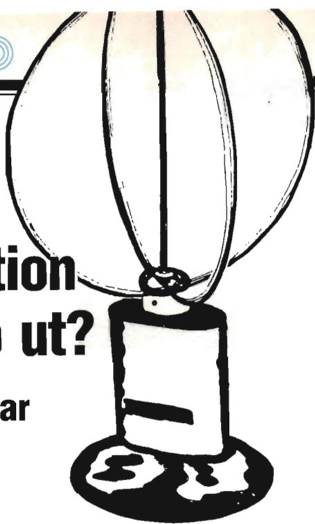
Fig 1. Så här ser antennen ut till den intressanta mottagare som Pioneer har tagit fram, där problemen med "multipath"-distorsion till stor del är lösta. De två slingorna kopplas in i taget. Mottagaren gör en omkoppling när sådan utbredningsdistorsion uppträder. Praktiskt taget alltid får man då bättre resultat i den andra slingan.
