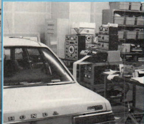
Fig 9. Provningsar av bilradio görs även praktiskt i bilar. I labbet på bilden kan, som synes, bilarna köra in för praktiska prov samt elektriska och akustiska mätningar.
