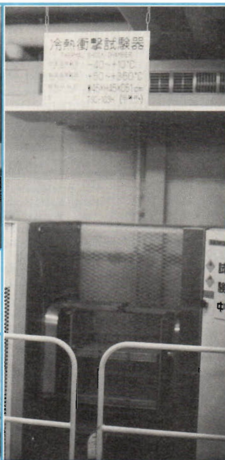
Fig 7. En del av produktionen tas regelbundet ut för kontroller av olika slag. Bilden visar klimatkammare med låg resp hög temperatur. Mellan dem slussas testobjektet. Det här är onekligen ett hårt prov!
