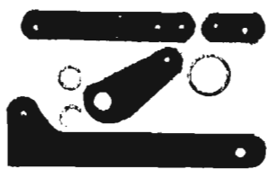
Fig 5. Mönsterkort till antenn-plinten i skala 1:1.
