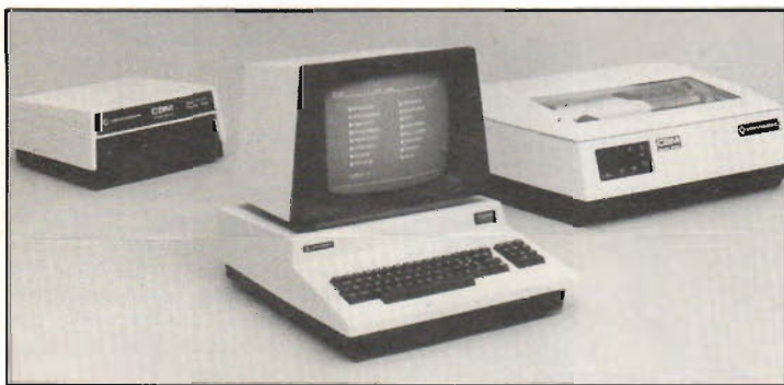
Fig 1. Så här ser det nya Pet 8000-systemet ut som vi nämnde vid föregående "dumping" av nyheter. Skärmen rymmer 80 tecken och flexskivminnet 1,05 Mbyte. Främst är det avsett för administrativa smådatortillämpningar. Det finns nu i Sverige, men vi väntar fortfarande på den intressanta lågprisdatorn Commodore VIC.
